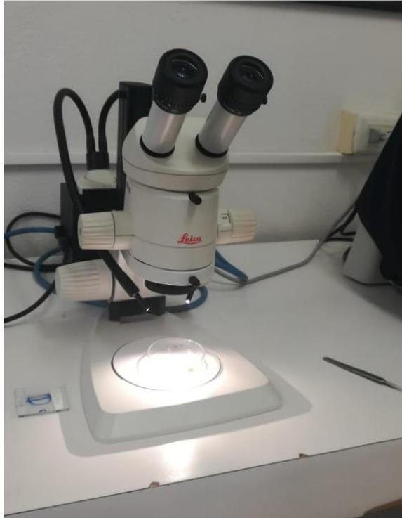
Figura 17. La figura muestra los objetos necesarios para realizar la separación manual de circones a la izquierda de la imagen es visible una placa de vidrio, en el centro una placa Petri montada sobre un Estereomicroscopio Leica y a la derecha unas pinzas de selección.
