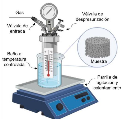
**Figura 11.** Configuración del sistema de alta presión para adsorción de gases a temperatura controlada.
