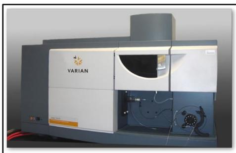
**Figura 4.10** Equipo de ICP-OES, marca Varian modelo 730-ES.
