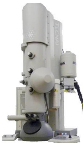
Figura 4.8: Equipo TECNAI F30 (300 kV) del LINAN IPICYT. Figura adaptada de [www.linan-ipicyt.mx/Microscopio HR-TEM.html](http://www.linan-ipicyt.mx/Microscopio HR-TEM.html)
