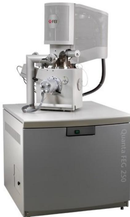
Figura 4.6: Fotografía del equipo FEI/ESEM QUANTA FEG/250M disponible en el LINAN - IPICYT. Figura adaptada de [www.linan-ipicyt.mx/Microscopio de Barrido.html](http://www.linan-ipicyt.mx/Microscopio de Barrido.html)
