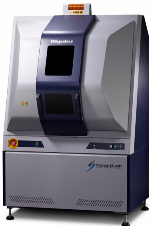
Figura 4.10: Difractómetro de Rayos X-SmartLab RIGAKU del LINAN IPICYT. Imagen tomada de la página web del LINAN [http://www.linan-ipicyt.mx/XRD\\_Bruker\\_D8\\_Advance.html](http://www.linan-ipicyt.mx/XRD_Bruker_D8_Advance.html), accesada 8 marzo 2022.
