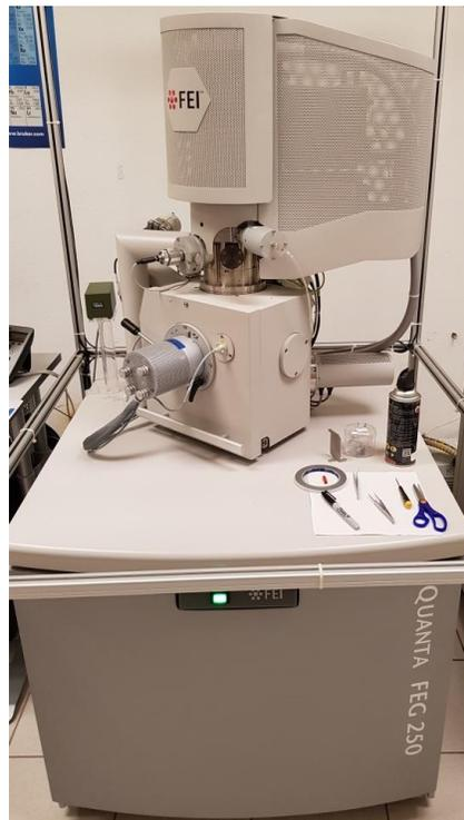
**Figura 2.8.** Microscopio electrónico de barrido FEI modelo QUANTA FEG 250.
