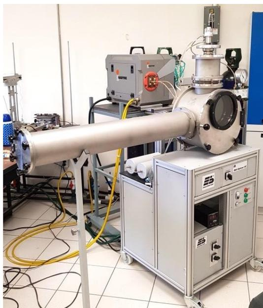
**Figura 2.3.** Equipo de temple rotatorio modelo SC de la firma Edmund Bühler GmbH utilizado para elaborar las cintas de las aleaciones que se consolidaron por SPS en el presente trabajo.
