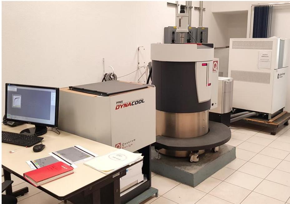
**Figura 2.9.** PPMS Dynacool 9 T de Quantum Design en el que se hicieron las mediciones de magnetización del presente trabajo.
