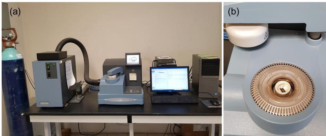
**Figura 2.6.** Calorímetro diferencial de barrido modelo Q200 de la firma TA Instruments utilizado en el presente trabajo. Vista general (a) e interior de la cámara de medición (b).
