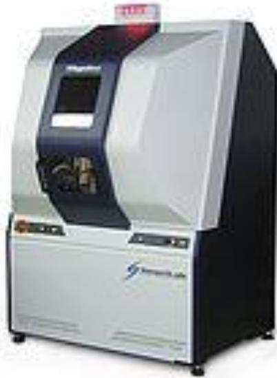
**Figura A1.8.** Difractómetro de Rayos -X – SmartLab RIGAKU
