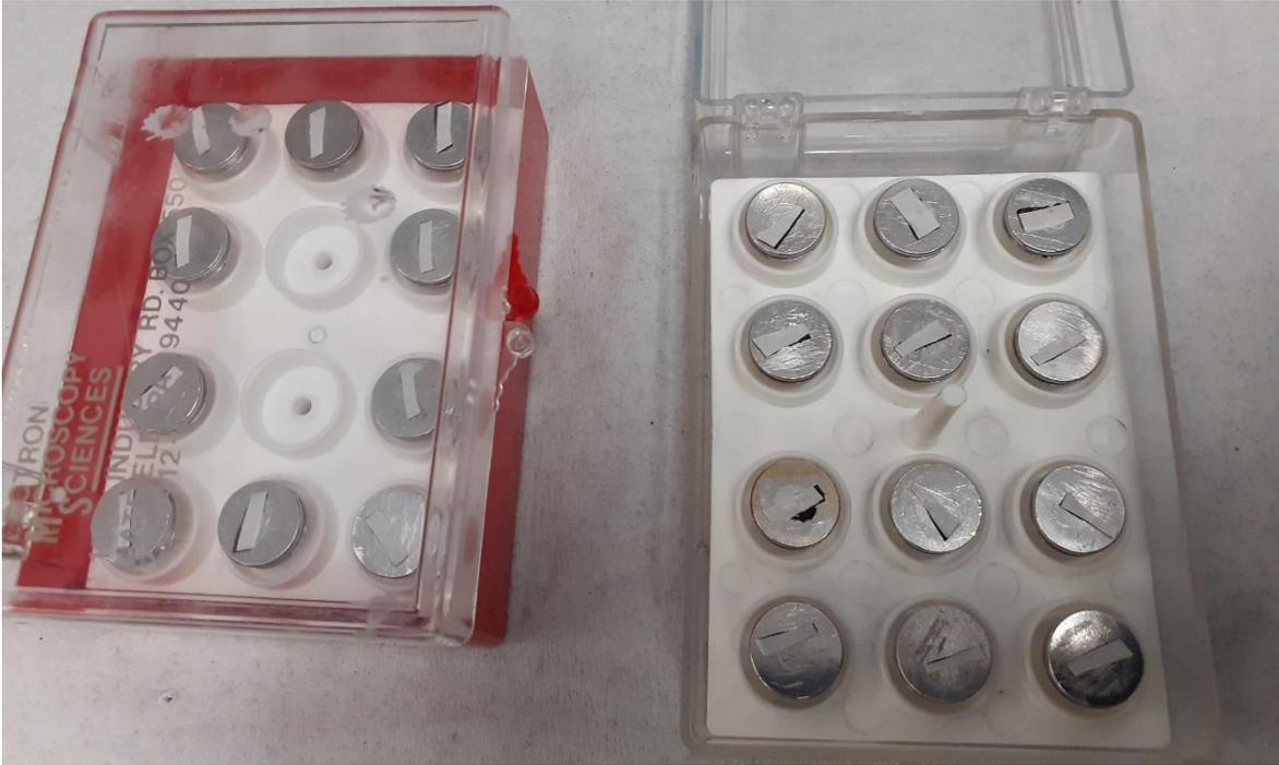
**Figura A1.1.** Pines con la cinta de carbono previamente montados en las cajas y que fueron utilizados para este análisis.
