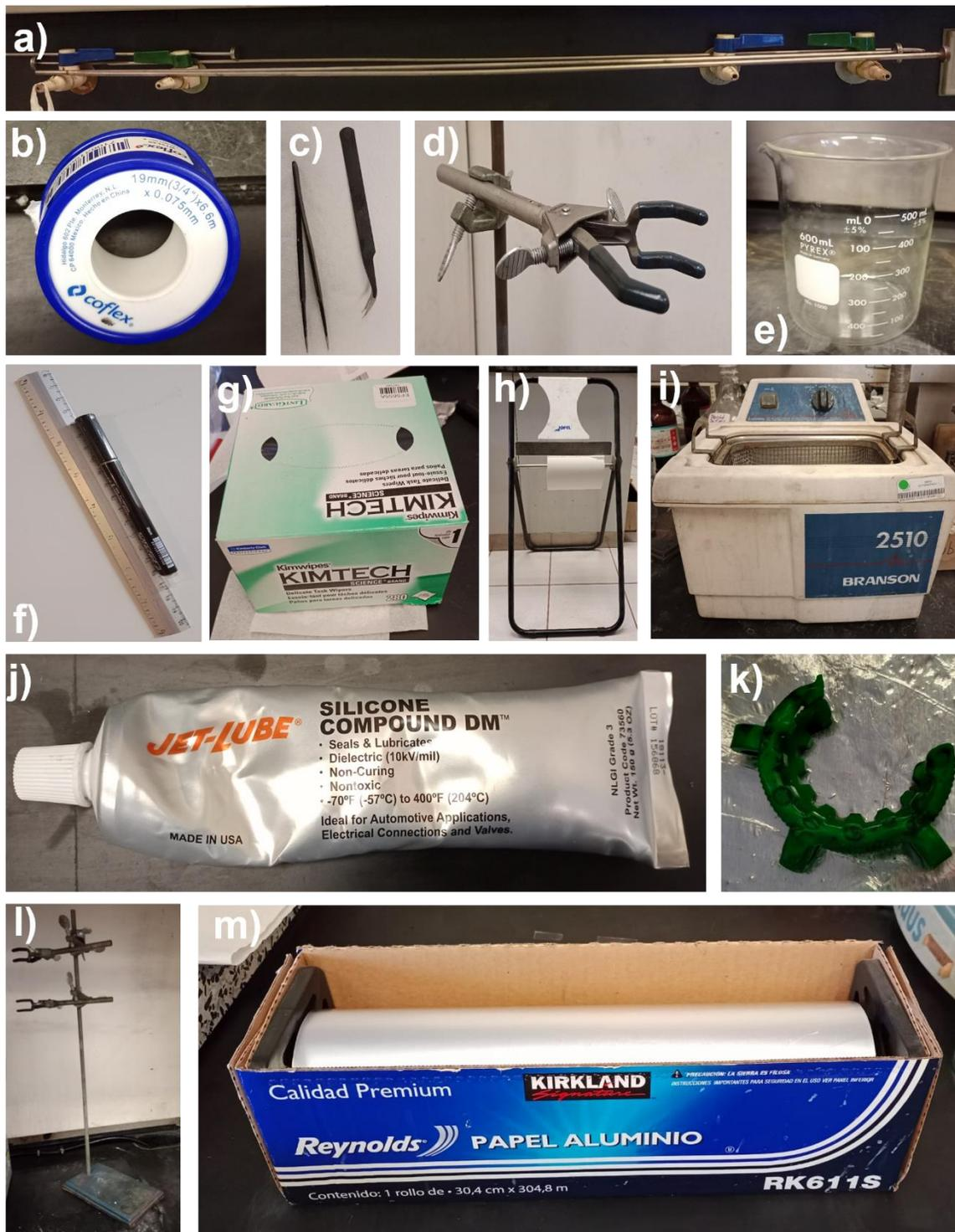
**Figura 2.2.** Materiales de apoyo para el proceso de síntesis. a) varilla de acero metal; b) cinta de teflón; c) pinzas de acero inoxidable; d) pinzas de tres dedos; e) vasos de precipitado; f) regla y plumón; g) toallas kimtech; h) papel; i) baño ultrasónico; j) la grasa de vacío; k) grapas; l) soportes; m) papel aluminio comercial kirkland.
