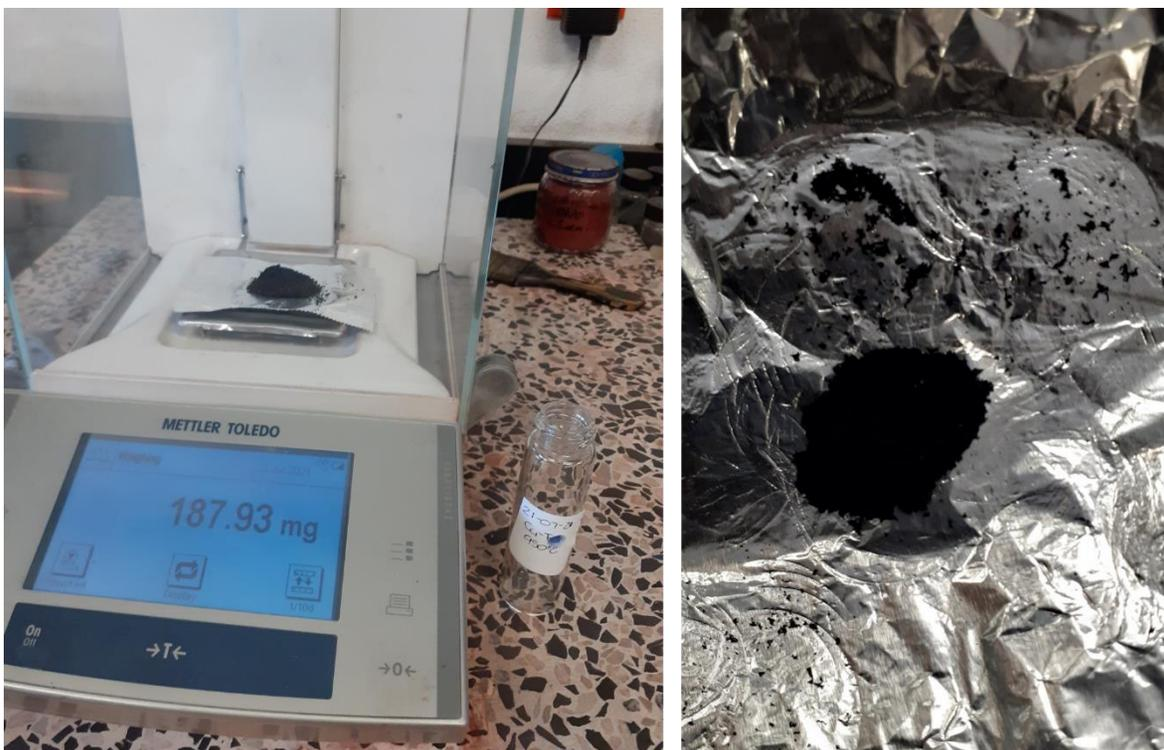
**Figura 2.10.** Ilustración de una de las muestras recolectadas al raspar el tubo, del lado izquierdo se observa el material sobre la báscula y de lado derecho el material recolectado.
