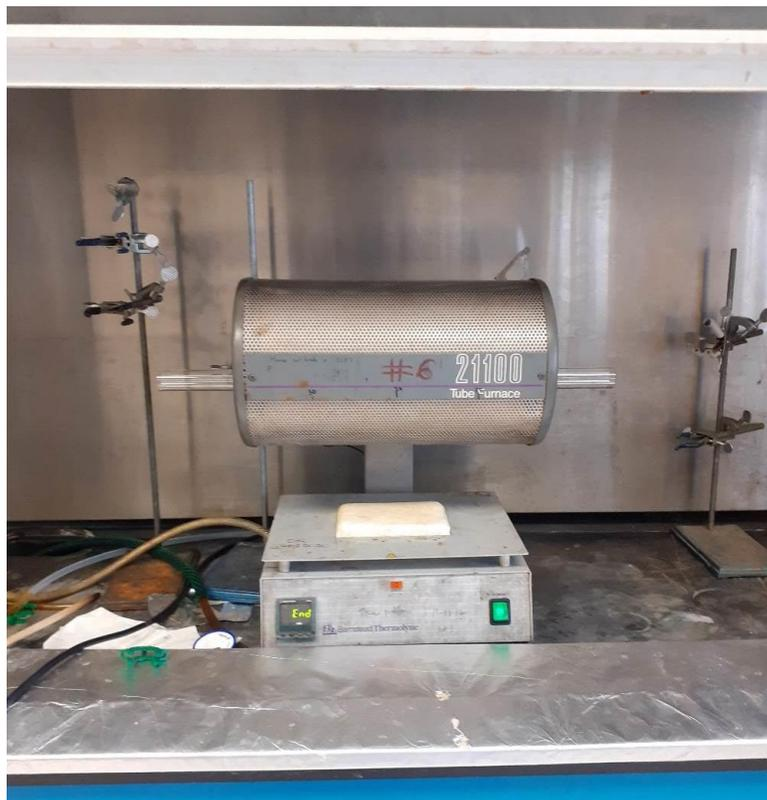
**Figura 2.11.** Muestra siendo sometida a oxidación.
