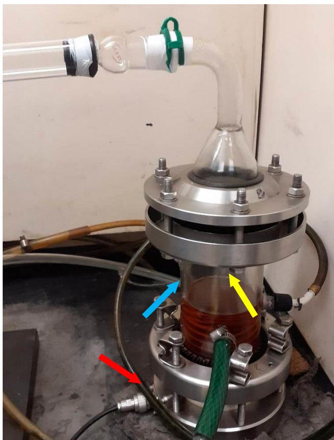
**Figura 2.5.** Cuerpo de nebulizador donde se aprecian las conexiones con terminación en rosca hacia el serpentín para el agua de enfriamiento (flecha azul), la conexión en rosca para el gas de arrastre (flecha amarilla) y la conexión al generador de frecuencias (flecha roja).
