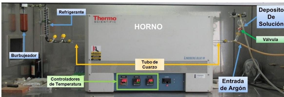
**Figura 31** Arreglo del sistema de pirólisis para la síntesis de nanotubos de carbono situado en el Lab. de Nanoestructuras y Dispositivos Orgánicos del IICO-UASLP (Dra. Marisol Reyes).
