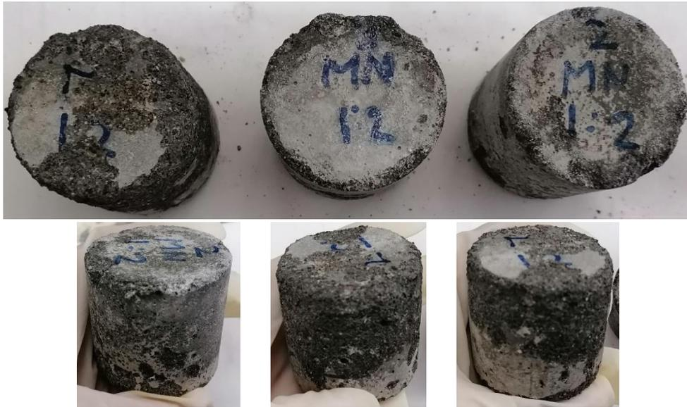
Fotografía 23. Mezcla MN 1:2 en el noveno ciclo de la prueba de ataques por sulfatos.
