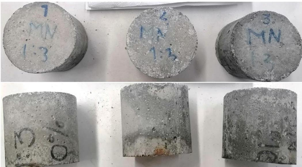
Fotografía 16. Probetas de la mezcla MN 1:3 en el séptimo ciclo de la prueba de ataques por sulfatos.
