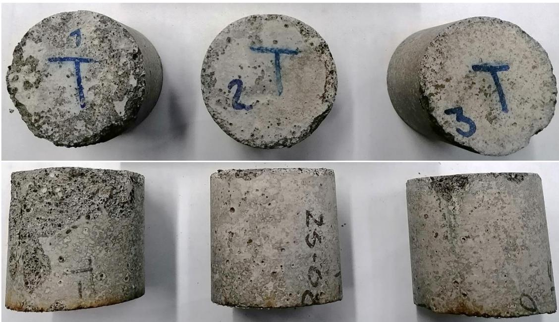
Fotografía 18. Octavo ciclo de prueba de ataques por sulfatos, en la imagen: probetas de la mezcla testigo.
