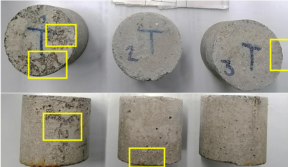
Fotografía 6. Probetas de la mezcla testigo en el cuarto ciclo. Es posible apreciar más daños superficiales en las probetas.
