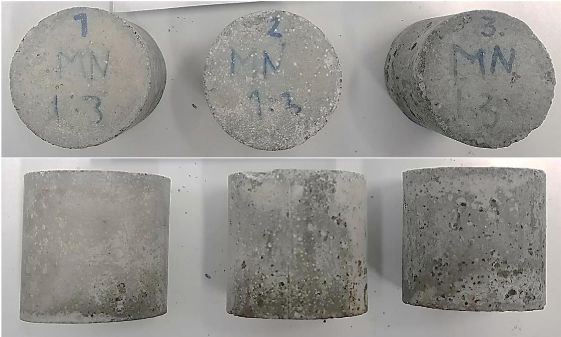
Fotografía 10. Especímenes de la mezcla MN 1:3 en el quinto ciclo de ataques por sulfatos.
