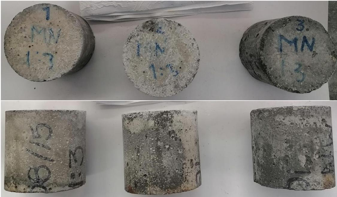
Fotografía 13. Probetas de la mezcla MN 1:3 en el sexto ciclo de ataque por sulfatos.
