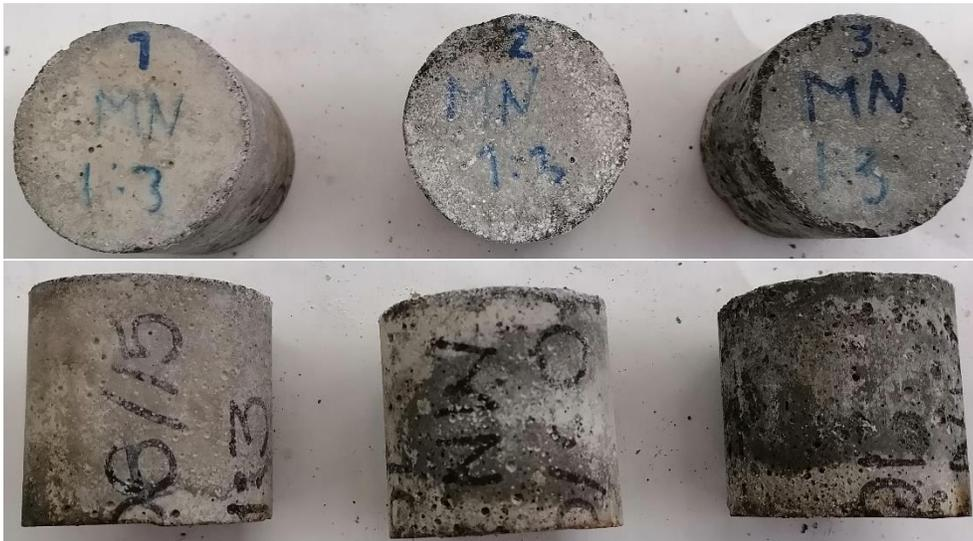
Fotografía 22. Mezcla MN 1:3 en el noveno ciclo de ataques por sulfatos.
