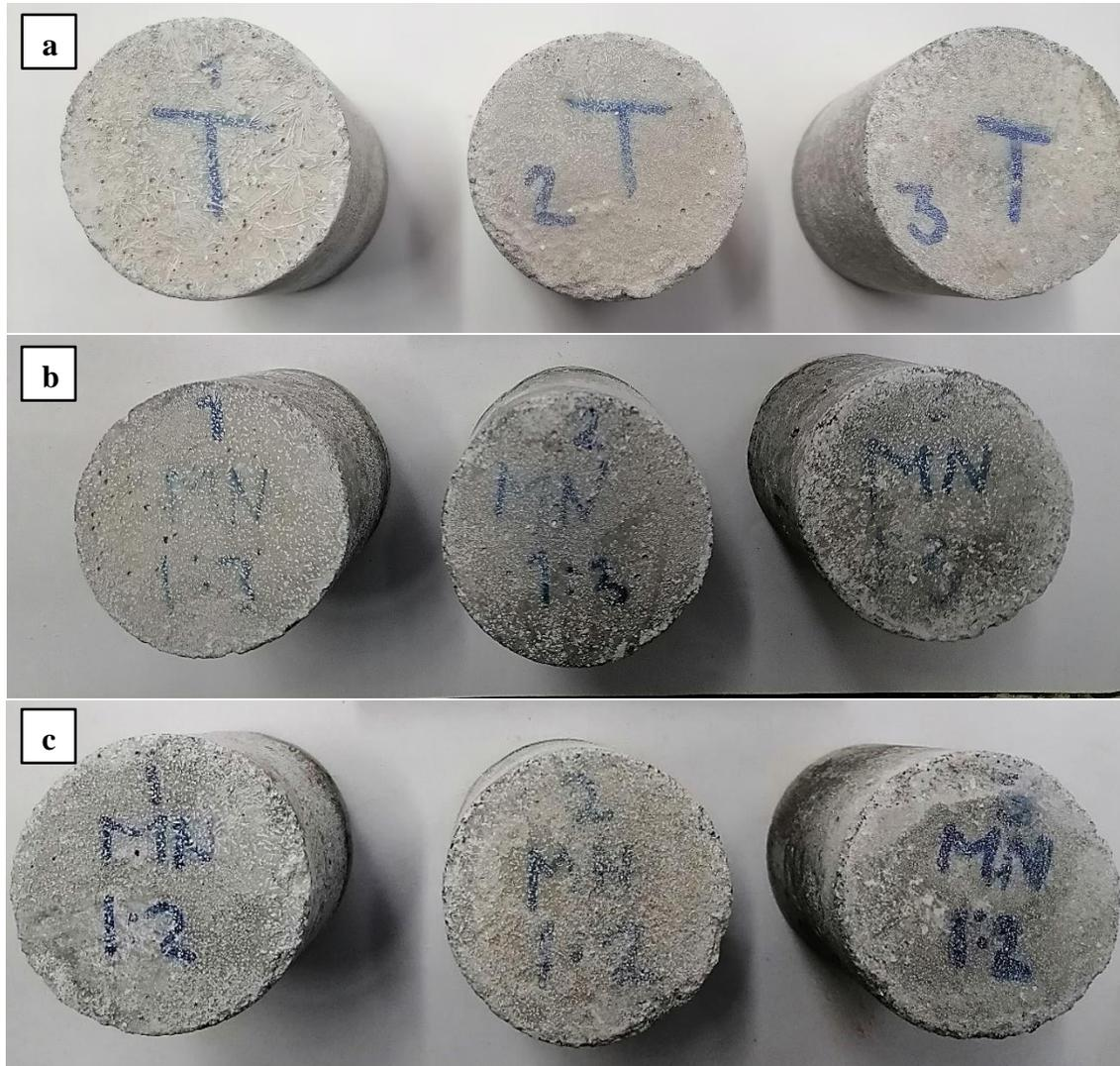
Fotografía 2. Primer ciclo de ataques por sulfatos donde a) son las probetas de la mezcla testigo, b) son las probetas de la mezcla MN 1:3 y c) probetas de la mezcla MN 1:2.
