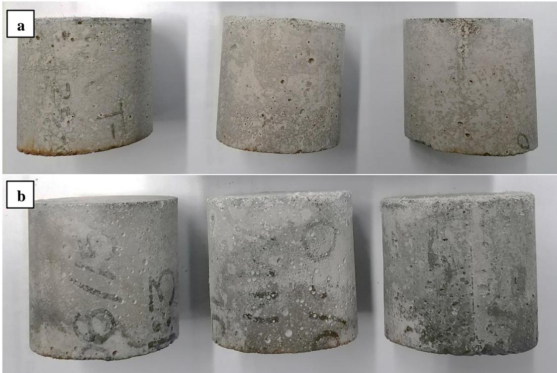
Fotografía 4. Tercer ciclo de ataques por sulfatos donde a) son las probetas de la mezcla testigo y b) son las probetas de la mezcla MN 1:3.
