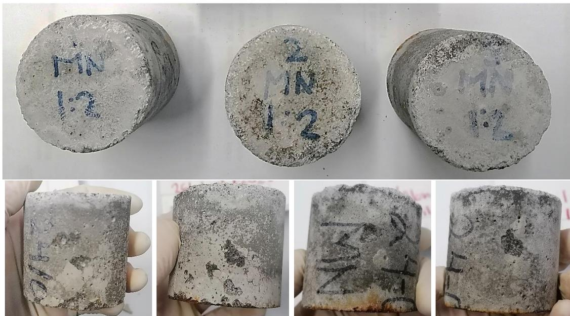
Fotografía 5. en las fotografías se muestran probetas de la mezcla MN 1:2, así como tomas de los desprendimientos que se empiezan a percibir en este ciclo.
