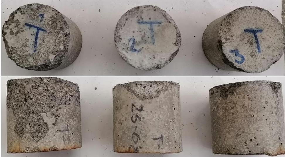
Fotografía 21. Mezcla testigo en el noveno ciclo de ataques por sulfatos.
