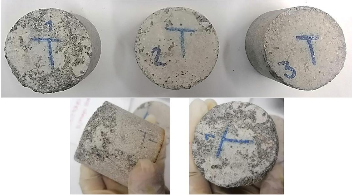
Fotografía 9. Mezcla testigo en el quinto ciclo de ataque por sulfatos. En la imagen es posible observar daños por desprendimientos en las caras superiores y caras laterales de los especímenes.
