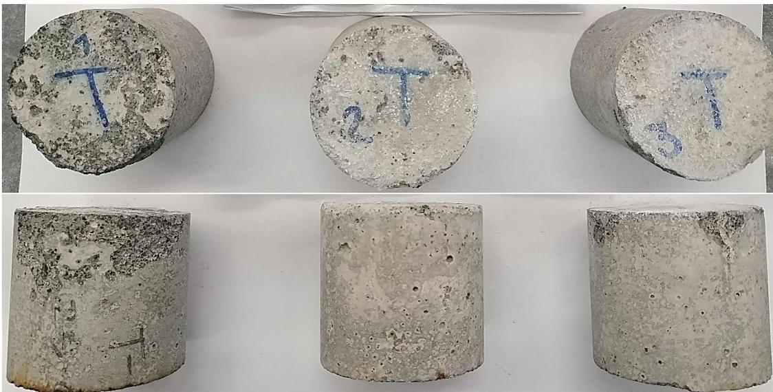
Fotografía 12. Probetas de la mezcla testigo en el sexto ciclo.
