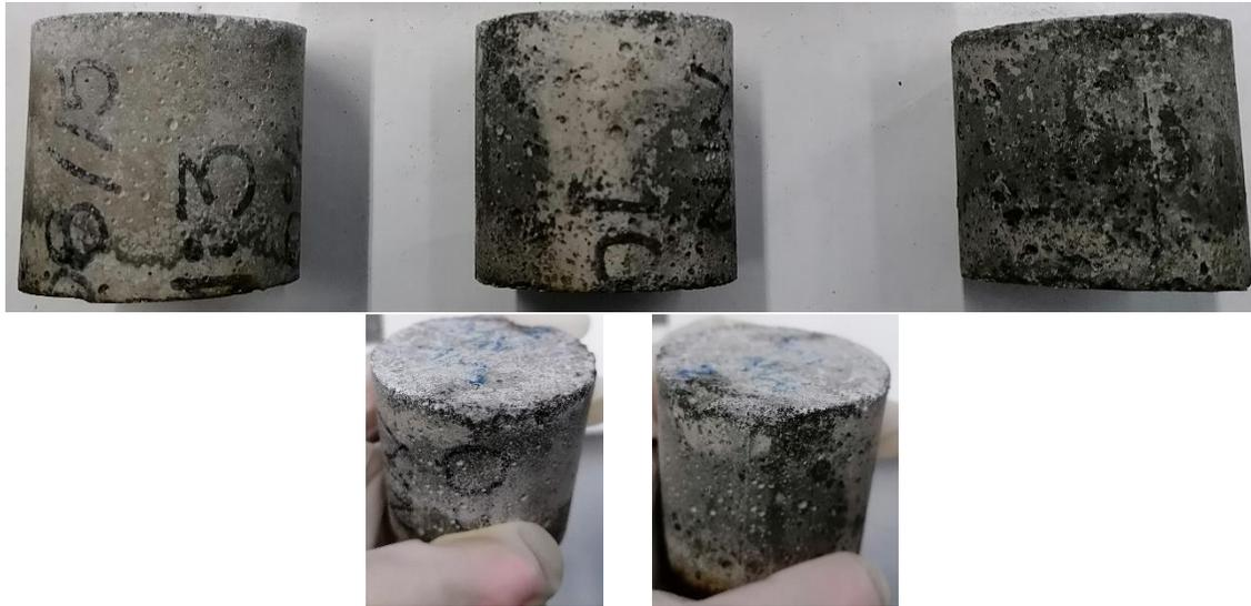
Fotografía 19. Octavo ciclo de la prueba de ataques por sulfatos. en la imagen: mezcla MN 1:3.
