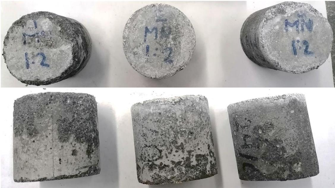
Fotografía 17. Probetas cilíndricas de la muestra MN 1:2 en el séptimo ciclo de la prueba de ataques por sulfatos.
