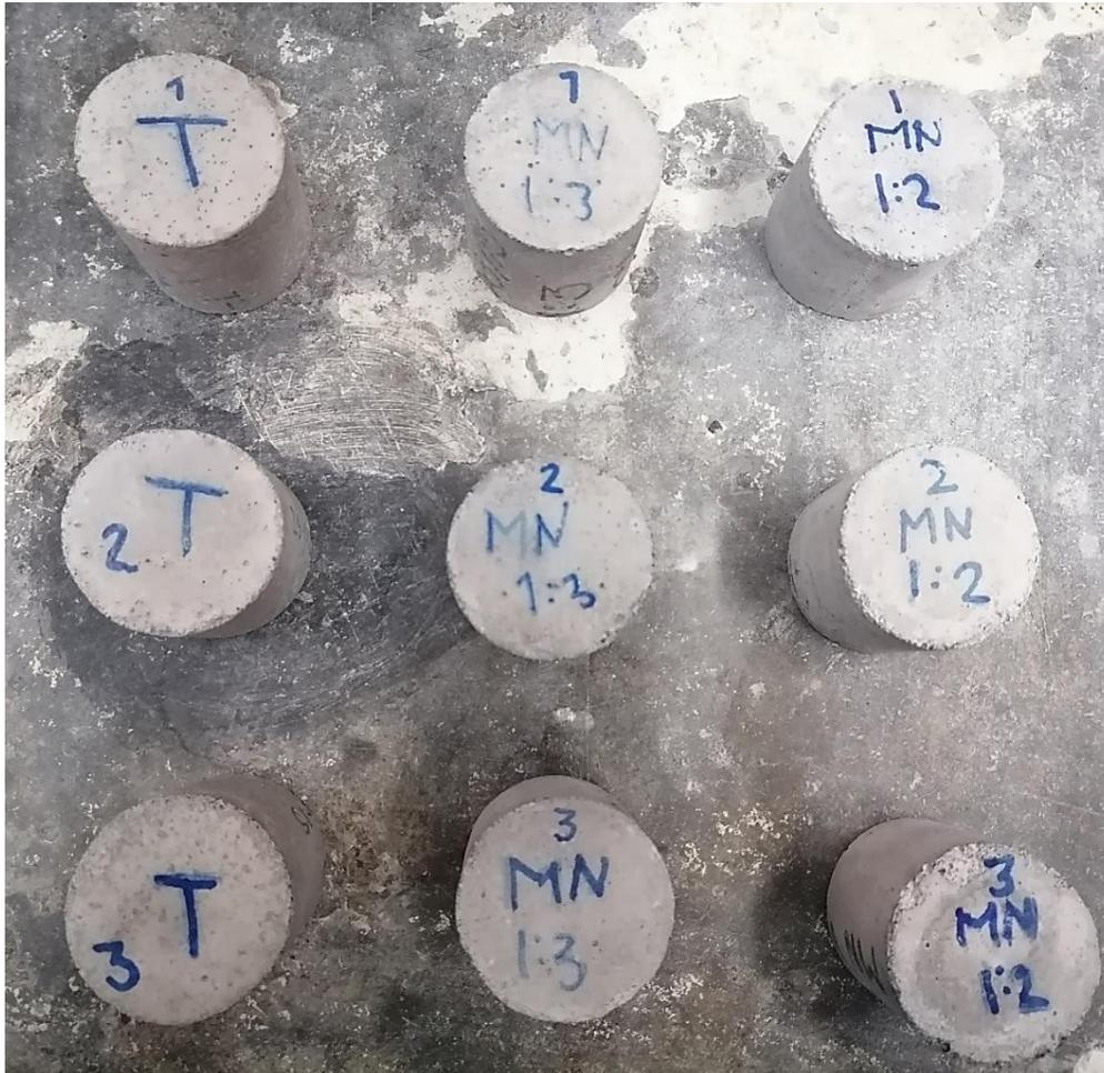
*Fotografía 1. Especímenes previos al ataque acelerado por sulfatos. Las probetas no presentan daños en su superficie, sólo algunas irregularidades debidas al proceso de colado.*
