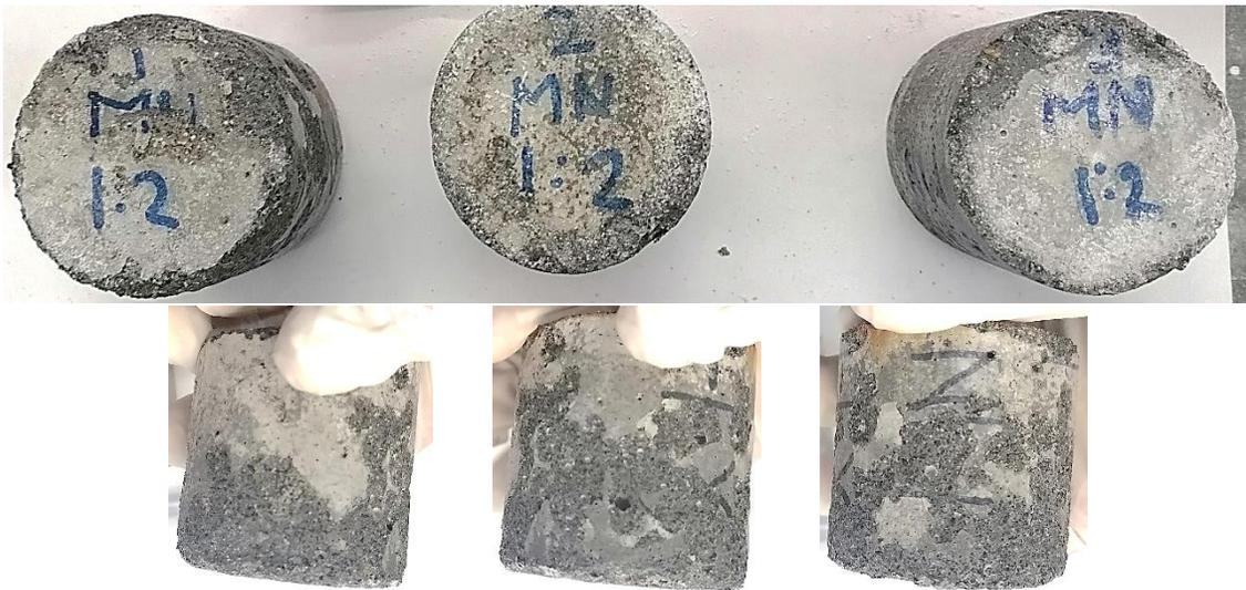
Fotografía 14. Muestras de la mezcla MN 1:2 en el sexto ciclo de la prueba de ataques por sulfatos.
