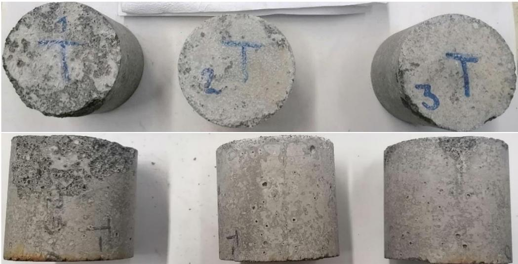
Fotografía 15. Mezcla testigo en séptimo ciclo de la prueba de ataques de sulfatos.
