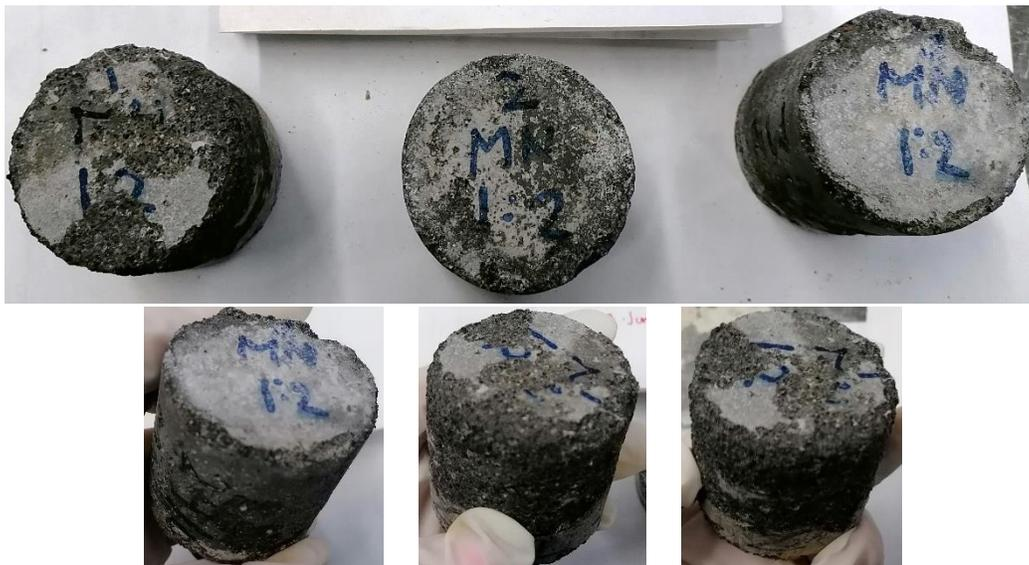
Fotografía 20. Octavo ciclo de la prueba de ataques por sulfatos, en la imagen: mezcla MN 1:2.
