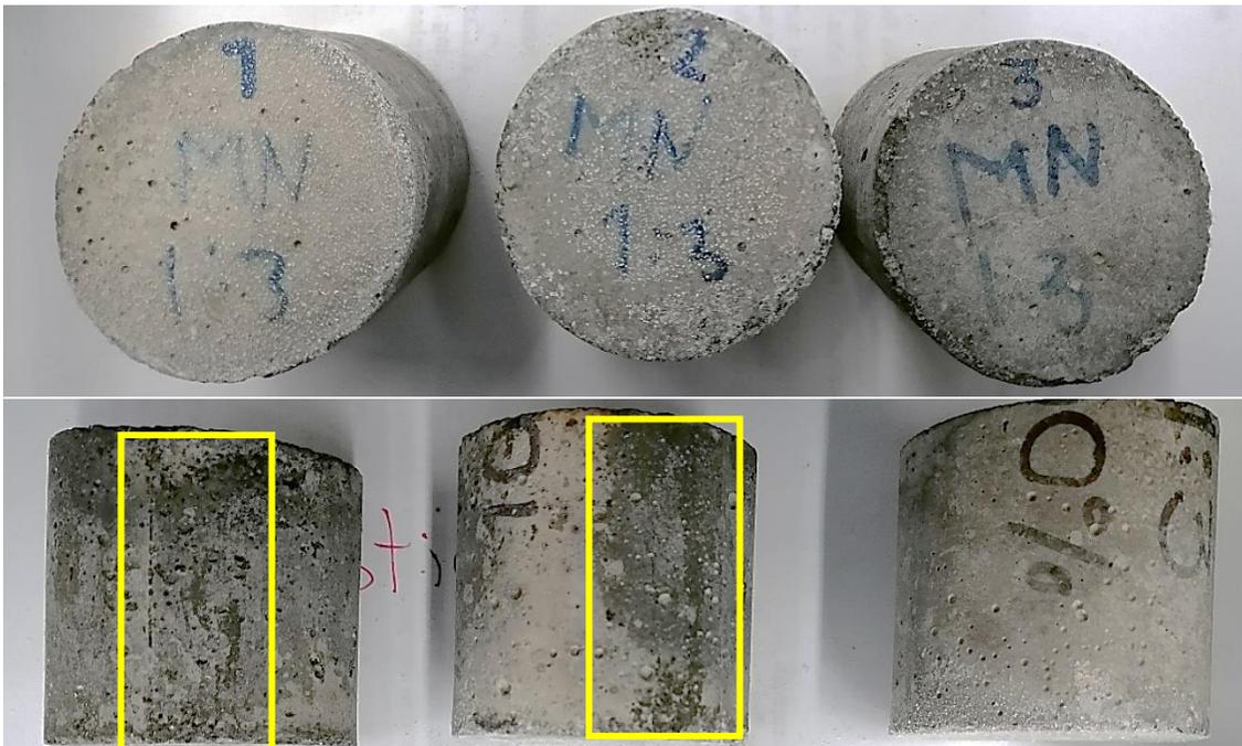
Fotografía 7. Probetas de la mezcla MN 1:3 en el cuarto ciclo. Se pueden observar daños en las caras laterales de dos de los especímenes.
