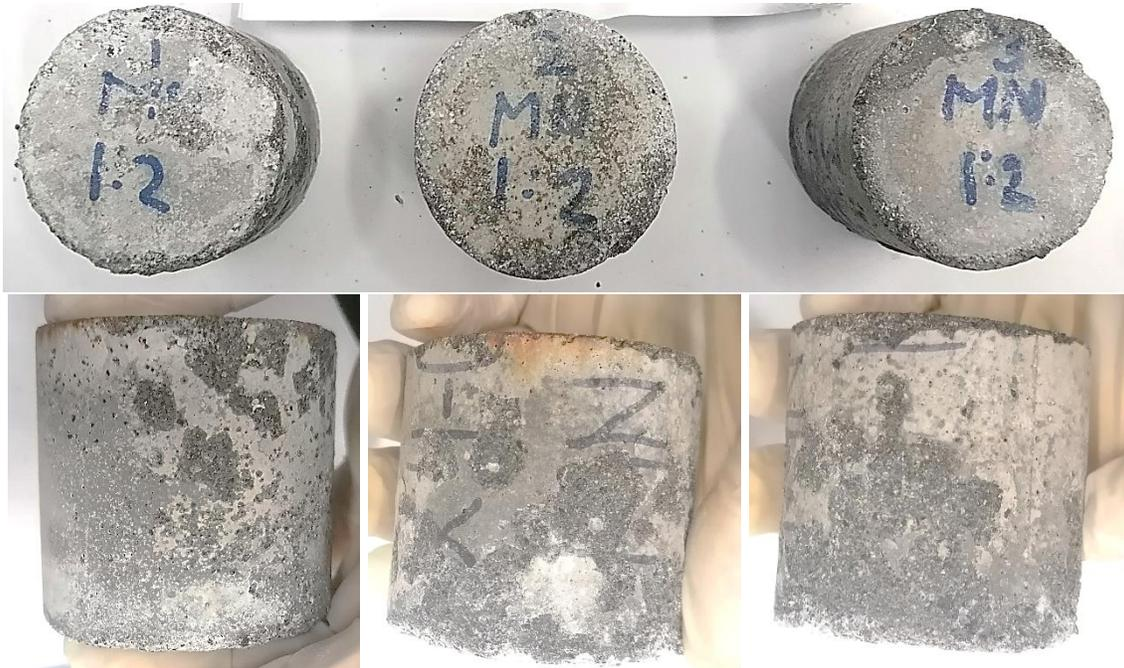
Fotografía 11. Probetas de la mezcla MN 1:2 en el quinto ciclo de ataques por sulfatos. En la revisión visual estás son las probetas que presentan más daños de desprendimientos de cobertura.
