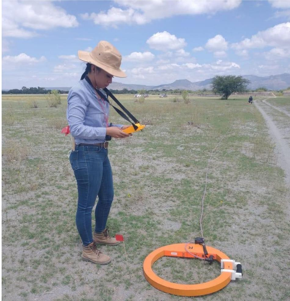
Figura 42 Fotografía del equipo CMD-DUO operando en campo con separación entre bobinas de 40 m, en polarización vertical, alcanzando una profundidad máxima de estudio de 60 m.
