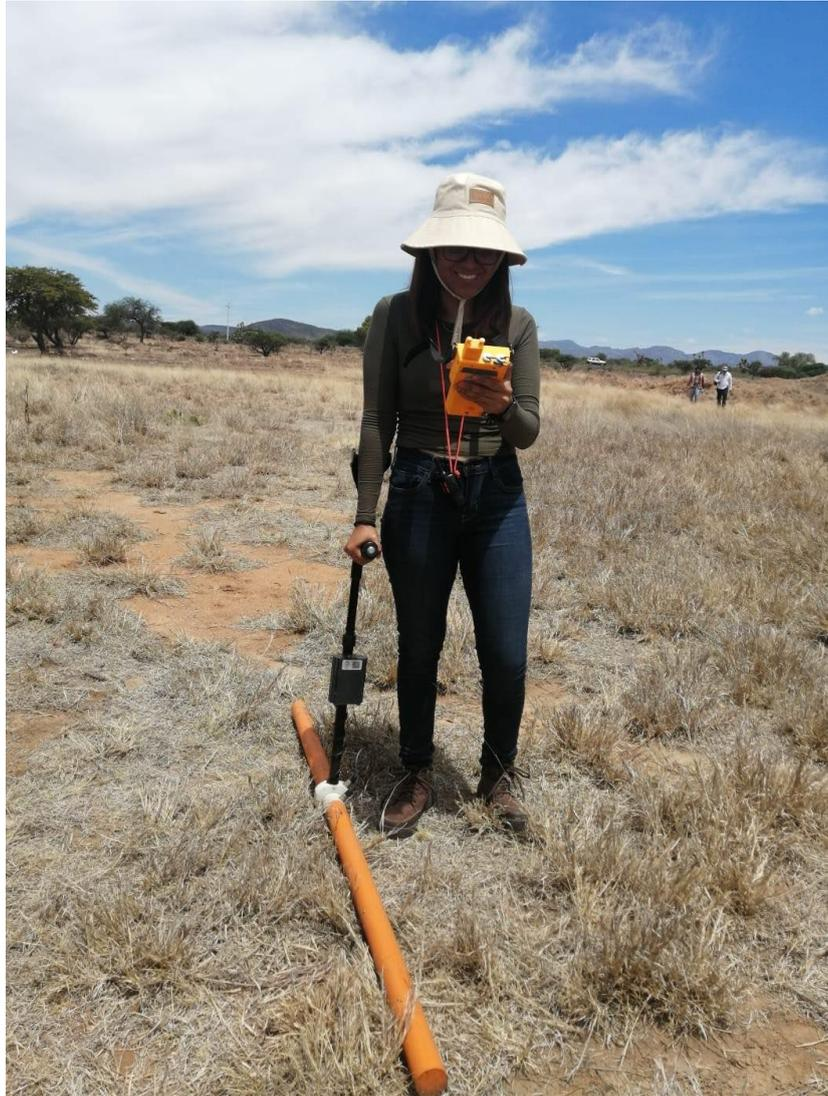
Figura 44 Fotografía del equipo CMD-Mini Explorer 6L operando en campo.
