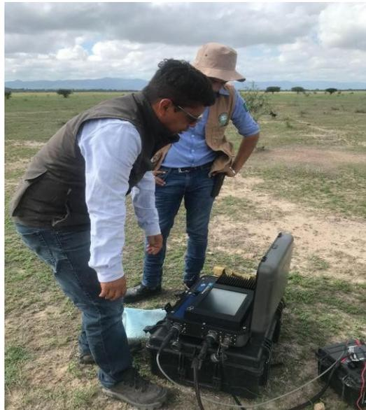
Figura 40 Equipo TerraTEM24 operando en campo.
