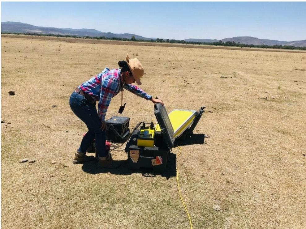
Figura 50 Fotografía del resistímetro SuperSting R8 operando en campo.
