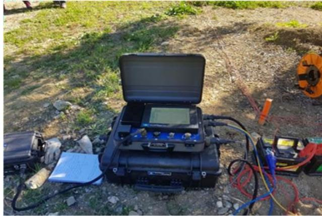
Figura 39 Equipo TerraTEM24 para la realización de los sondeos TEM. Imagen ilustrativa del equipo tomada de <https://www.progeo.es/>
