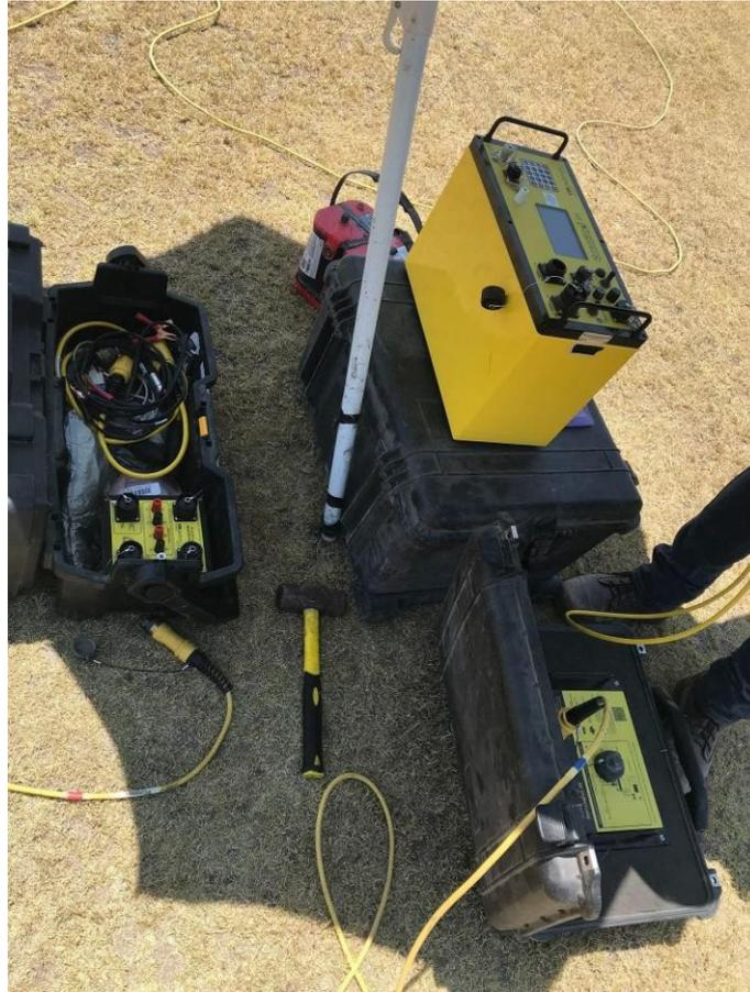
Figura 49 Fotografía del resistímetro SuperSting R8.
