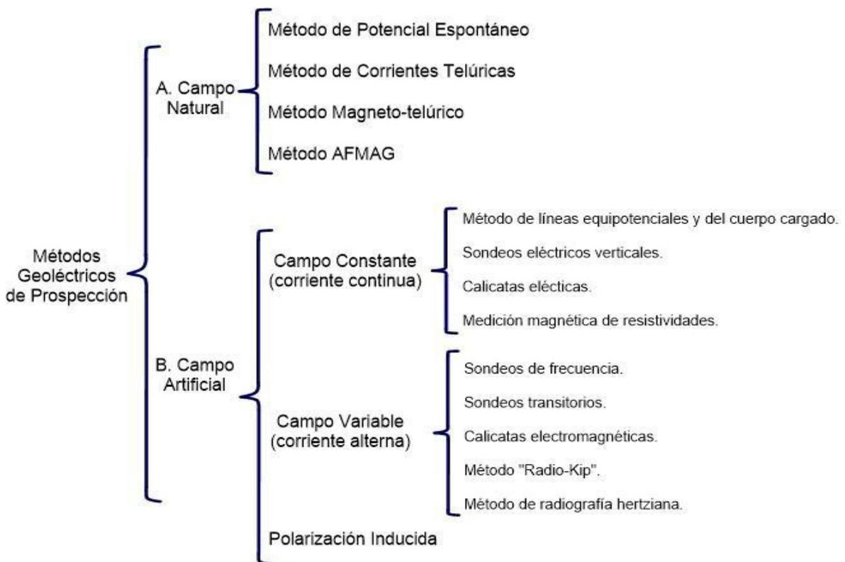
Figura 18. Clasificación de los métodos geoelectricos de acuerdo con Orellana (1972).
