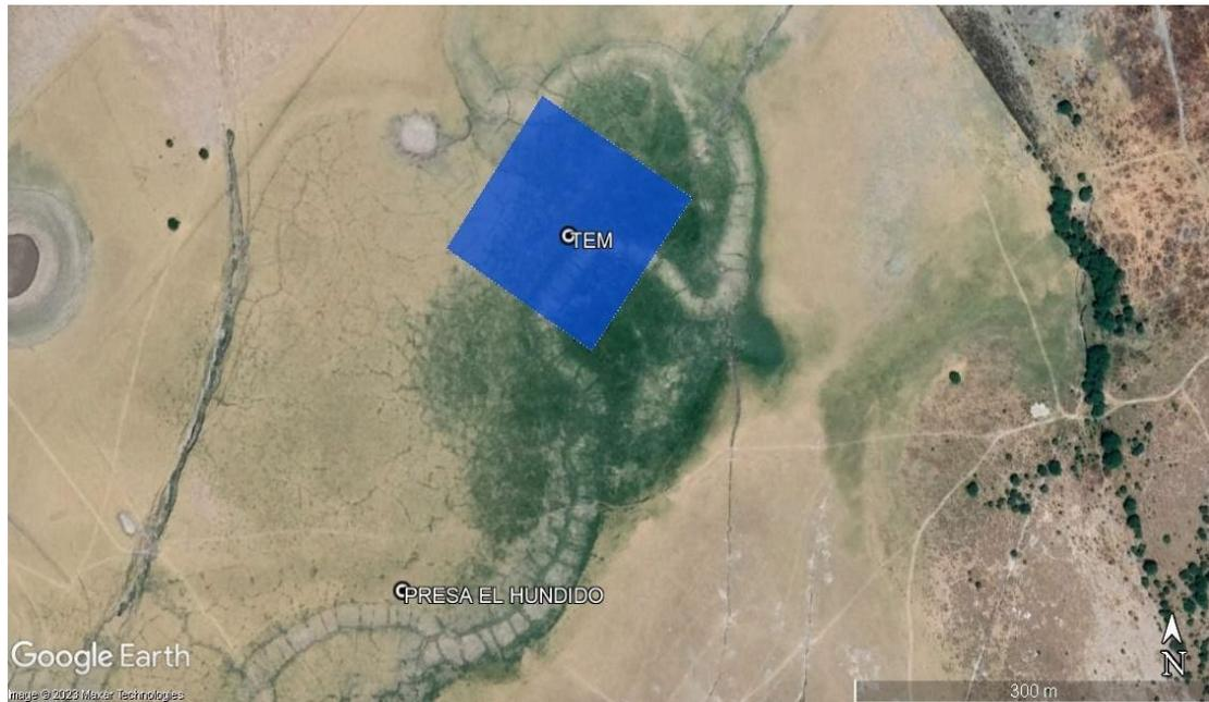
Figura 38 Imagen satelital de la localización del sondeo transitorio electromagnético dentro del vaso de la presa El Hundido.
