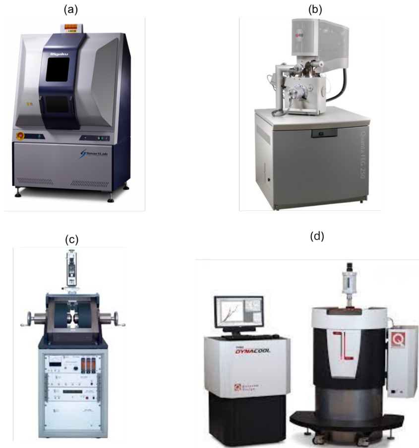
Figura 4.3: (a) Difractómetro de Rayos X, (b) Microscopio de Barrido Electrónico Ambiental, y (c) Magnetómetro de gradiente alternante (d) sistema PPMS Dynacool para magnetometría VSM.
