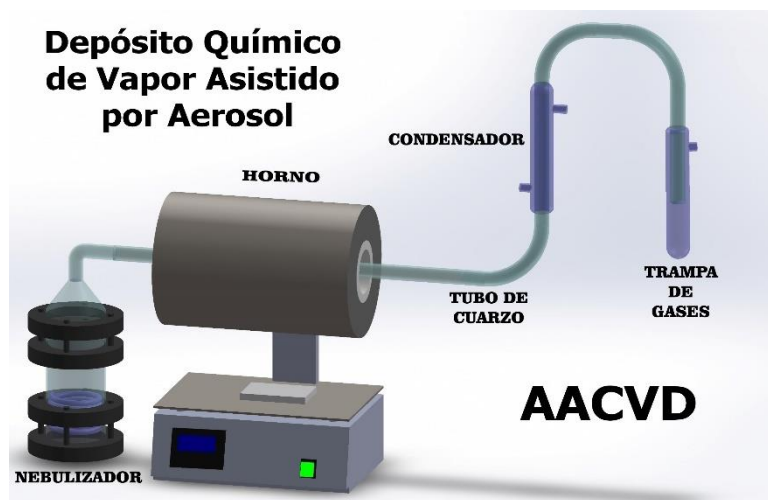
Figura 1.18 Representación esquemática del Sistema de depósito químico de vapor (CVD). Se muestran los componentes principales de este sistema.
