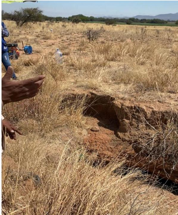
*Figura 5.11. Falla que atraviesa el primer perfil de TRE realizado con SuperSting™.*
