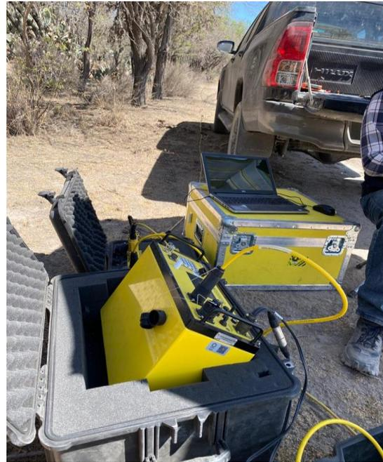
*Figura 5.18. Equipo en levantamiento de perfil 5 de TRE.*
