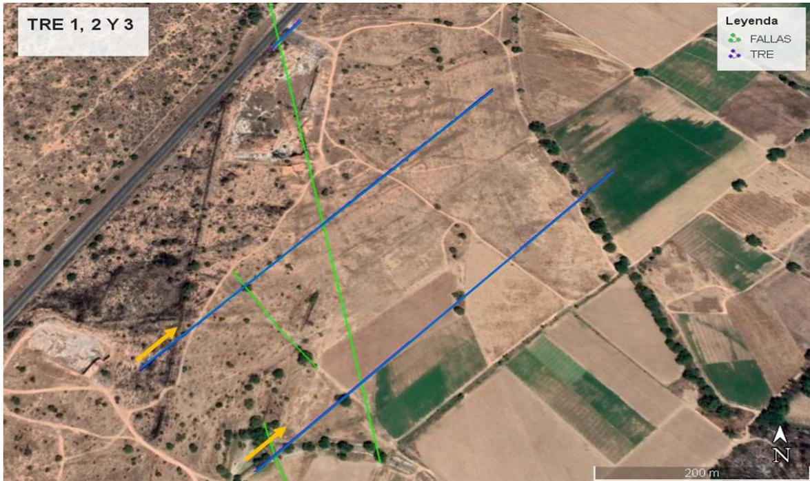
Figura 4.6. Localización del perfil de TRE (líneas azules) realizado con Syscal kid y perfiles 2 y 3 realizados con SuperSting™ con una flecha amarilla indicando su dirección, y líneas verdes señalando la localización de las fallas observadas
