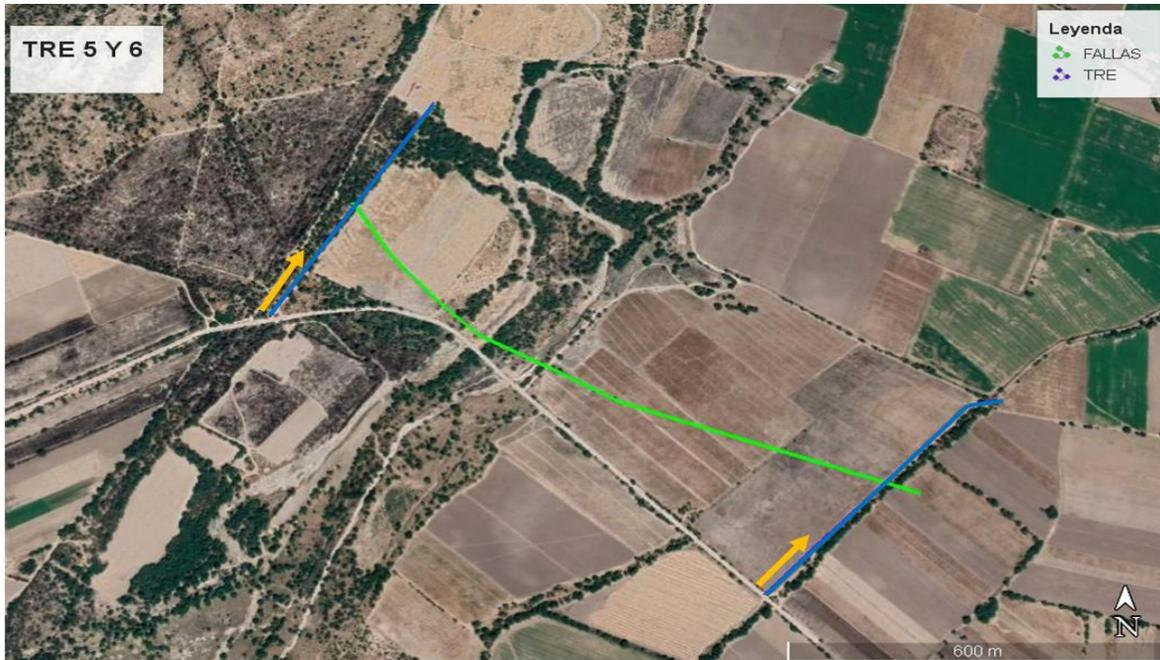
Figura 4.8. Localización de los perfiles de TRE 5 y 6 (líneas azules), con una flecha amarilla indicando su dirección y líneas verdes señalando la localización de las fallas observadas.
