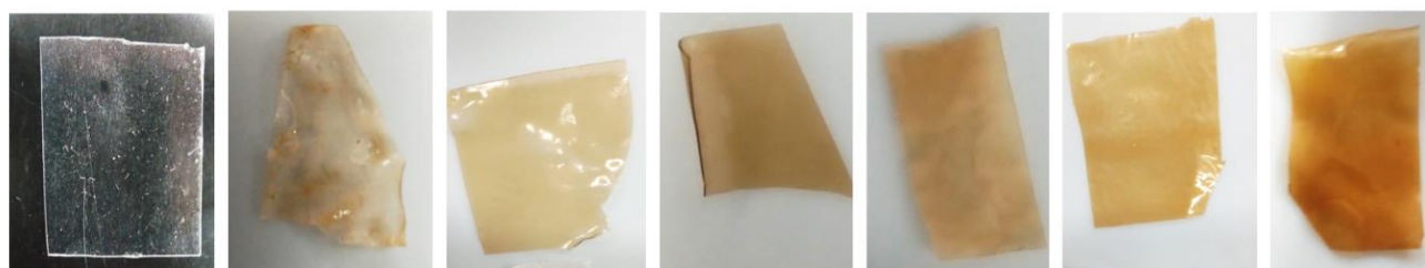
Fig 12. Fotografías de las membranas SEBS (a la izquierda) y sSEBS con tiempos de sulfonación de 2, 3, 5, 10, 30 y 60 minutos (de izquierda a derecha).
