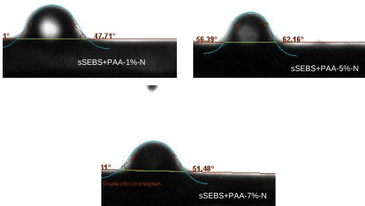
Fig. C3. Ángulo de contacto de las membranas compuestas por SEBS y PAA sometidas al proceso de sulfonación seguido de la neutralización.
