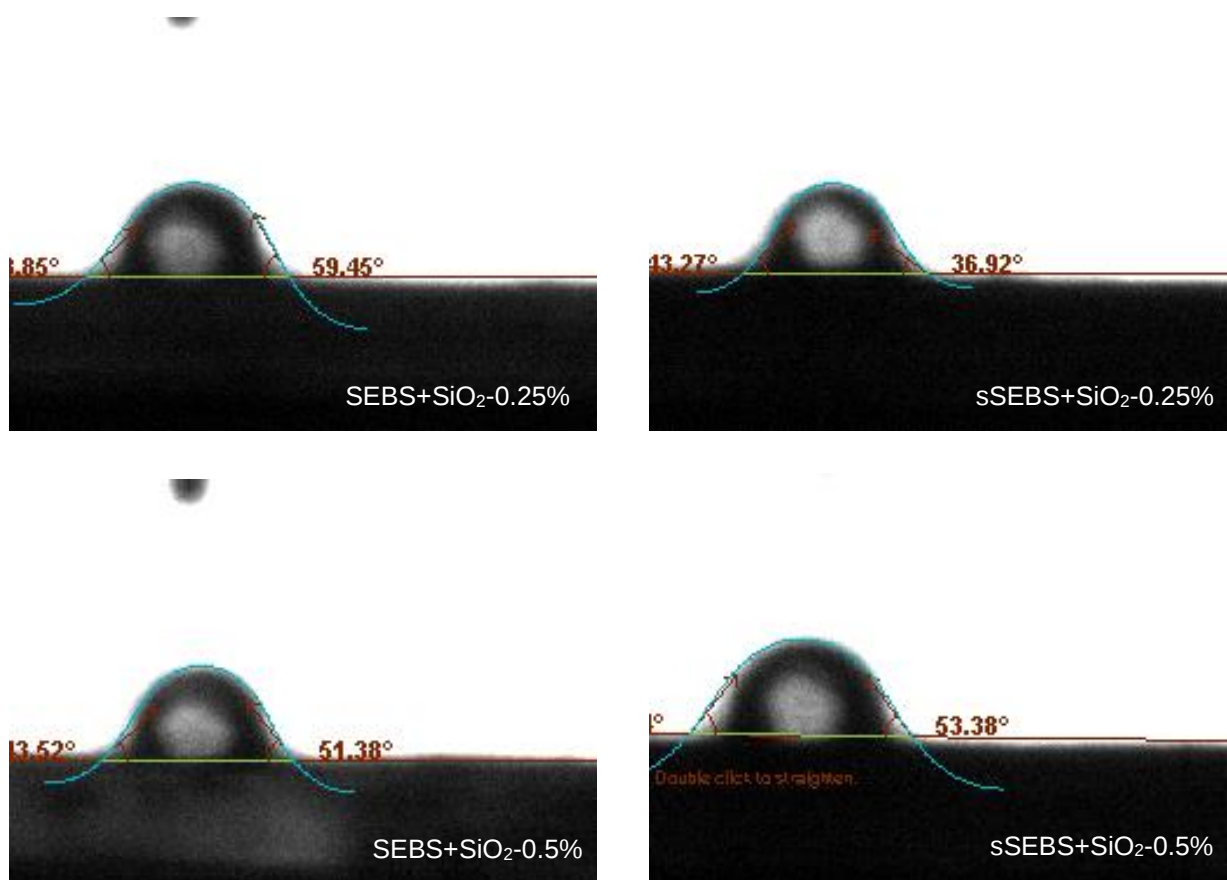
Fig C5. Ángulo de contacto de las muestras compuestas por SEBS con diferentes concentraciones de óxido de silicio, a la izquierda las membranas sin sulfonar y a la derecha sulfonadas
