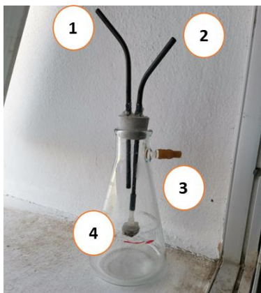
Figura I. Fotografía de un matraz Kitasato adaptado para funcionar como tanque agitado. 1) Entrada del fermentado procedente del reactor; 2) Salida del tanque, por la cual el fermentado retorna al reactor; 3) Salida de gas conectada a una probeta con agua para medir el gas generado dentro del matraz mediante desplazamiento de volumen; 4) Filtro que impide el paso de la resina al reactor.
