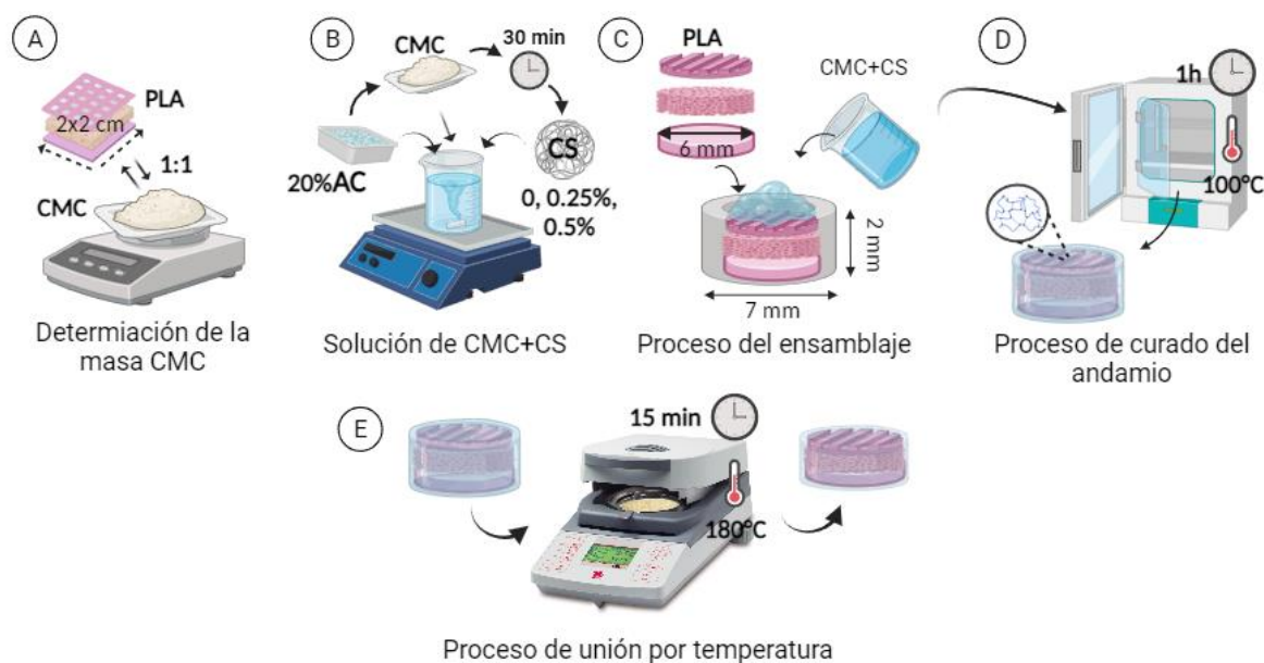
Figura 6.1. Esquema de la metodología propuesta para construir andamios poliméricos multicapa. (a) determinación de la cantidad de CMC; (b) formulación de la solución de anclaje; (c) montaje del andamio, (d) entrecruzamiento de los polímeros y (e) unión de las capas por temperatura.
