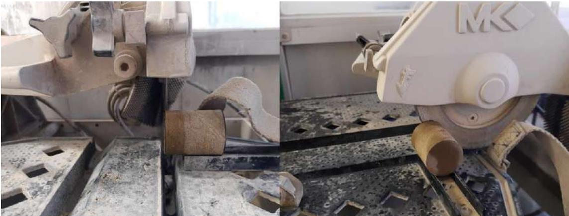
Figura 3-10 - Se observa un cilindro al que se busca hacer cortes ortogonales (Iz) para después pulir imperfecciones (D).
