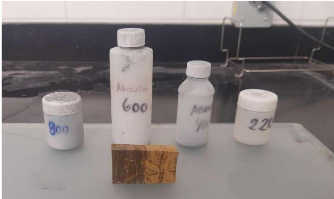
*Figura 3-5 - Muestra PAC - 01 A, antes de ser pulida con polvos abrasivos en preparación para la adhesión con portaobjetos.*
