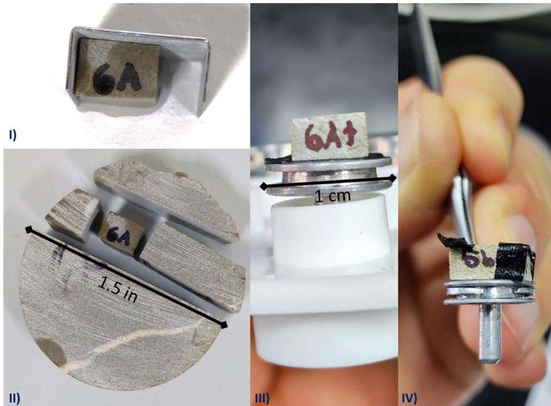
Figura 3-11 - La primera fotografía (I) muestra el tamaño final de un cubo para MEB. La segunda fotografía (II) muestra la sección de dónde se obtuvo la muestra, siendo obtenida de una sección delgada de un cilindro. La tercera fotografía (III) muestra la adhesión inicial al pin de aluminio mientras que la final (IV) muestra como deben de ser manipuladas las muestras con pinzas y recubiertas con la cinta de carbono para reducir la acumulación de carga durante el análisis MEB
