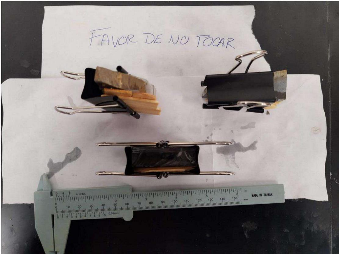
Figura 3-3 - Secciones recortadas de PAC - 01 B, PAC- 02 y PAC - 04A en proceso de adhesión a los portaobjetos.
