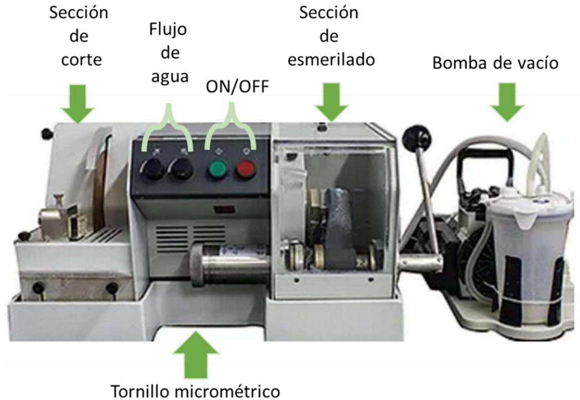
Figura 3-4 - Fotografía del equipo Discoplan - TS con leyendas por secciones.
