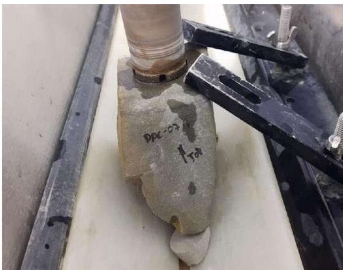
*Figura 3-9 - Muestra PAC - 07 A siendo procesada para obtener un núcleo/cilindro de 1.5 in de diámetro.*
