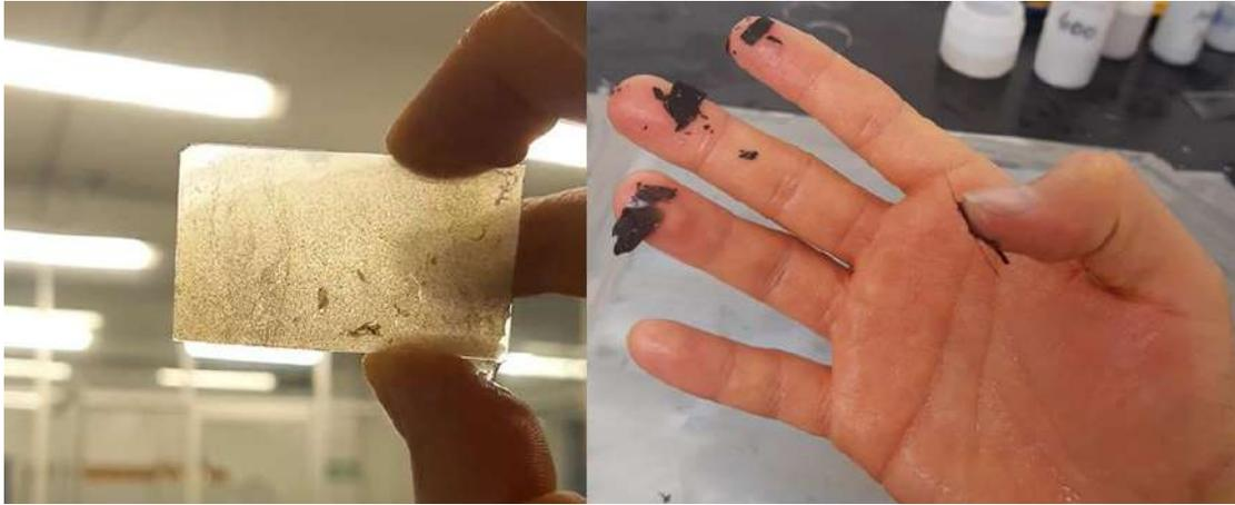
*Figura 3-7 - Se debe tener cuidado con el procesamiento de las láminas delgadas. Del lado izquierdo se observa una lámina terminada, mientras que en lado derecho se observan los restos de una lámina que por mala adhesión o por ser roca muy friable se desprendió del portaobjetos.*
