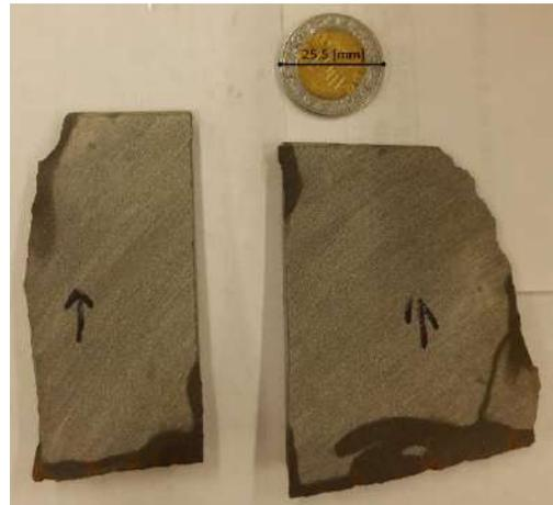
Figura 3-2 - Muestra de mano PAC - 07 B en preparación para lámina delgada.
