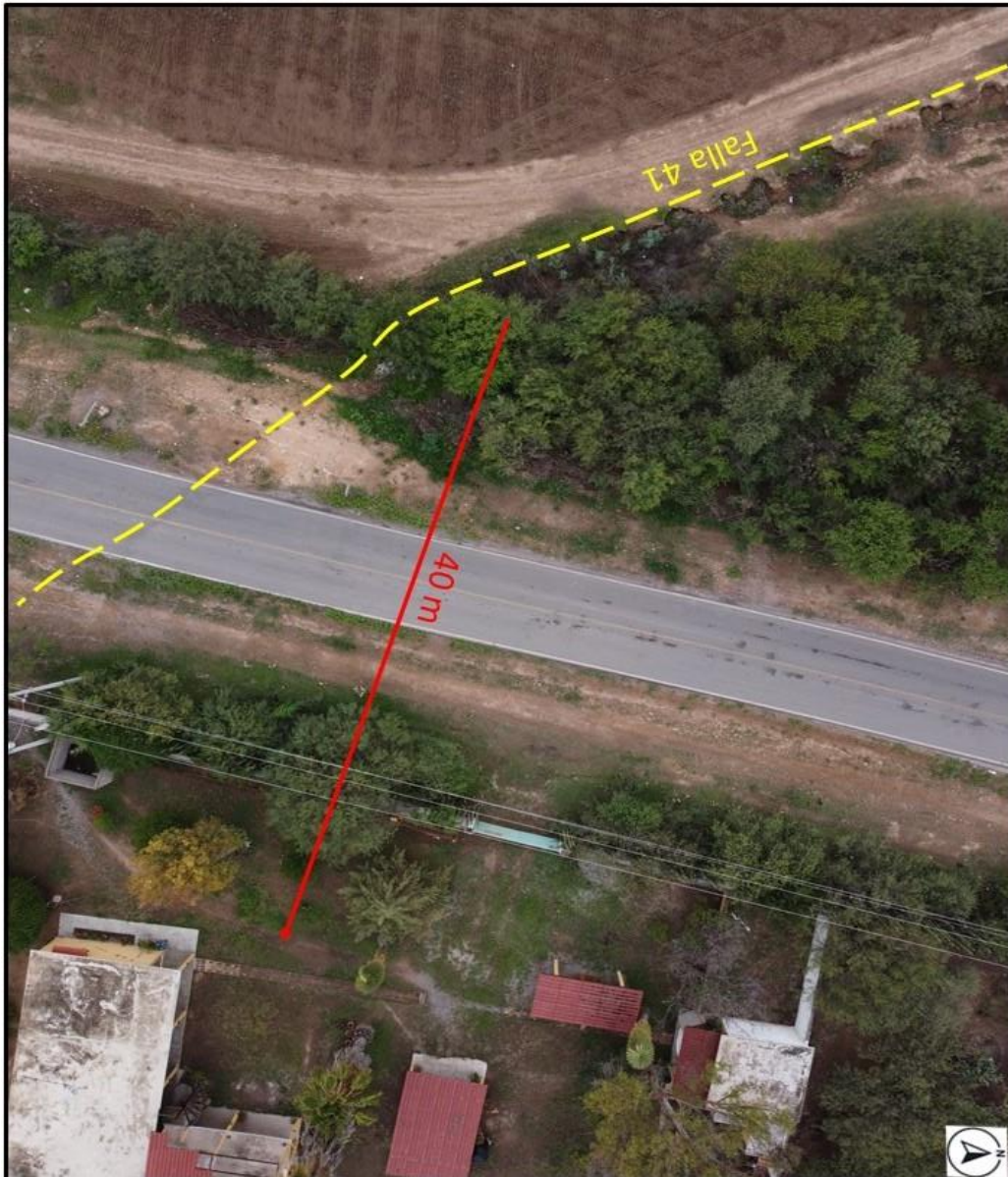
Figura 54. Fotografía aérea de la falla 41 (Bocas 3). Mide aproximadamente 2 km, atraviesa zonas de cultivo, así como la carretera y se encuentra a una distancia importante de una casa-habitación, lo que incrementa el riesgo por la existencia de esta falla.
