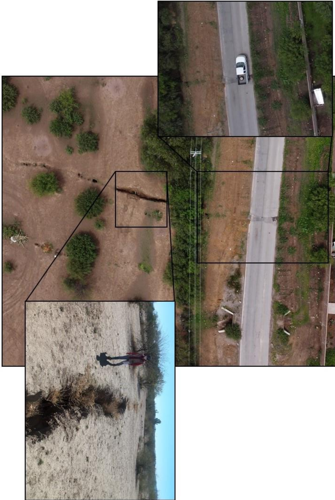
Figura 53. Riesgo y daño por falla "Bocas 1".Afectación de circulación de vehículos.
