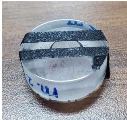
Figura 2. 3. Muestra montada en resina acrílica con cinta de carbono para su observación en SEM.
