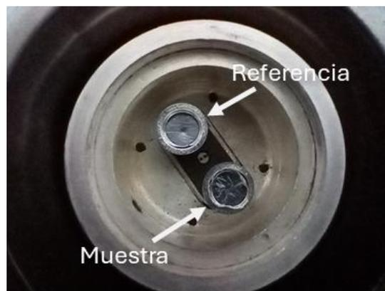
Figura 2. 4. Cámara de las muestras del calorímetro DSC Q200.
