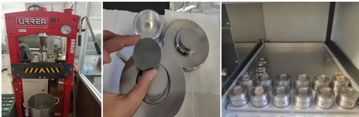
Figura 12. Proceso para la obtención de las pastillas que se analizarán en el FRX.
