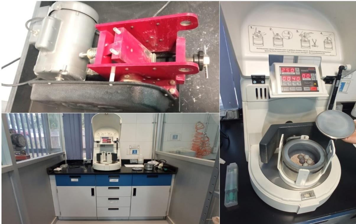
Figura 11. Proceso de corte y triturado de las muestras.
