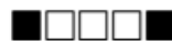
Figura 1.6: Representación gráfica de un vector con cinco componentes, representado con números el vector es S = \{-1, 1, 1, 1, -1\}
