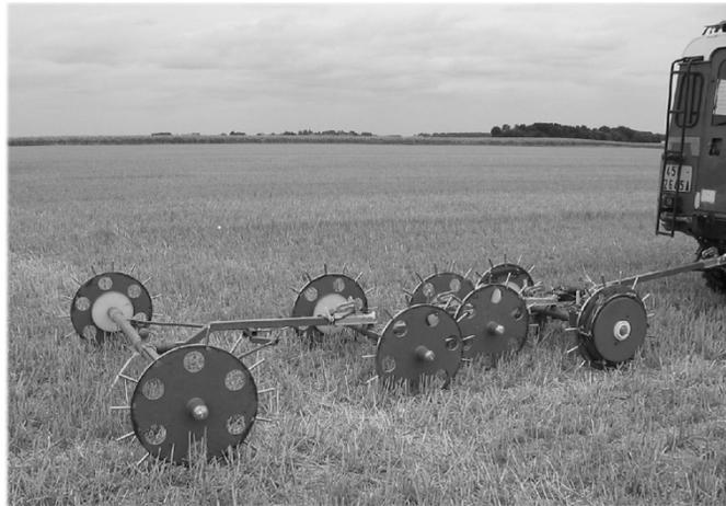
*Figura 28. Dispositivo MUCEP como ejemplo de innovación para aumentar la productividad del método PE en la determinación de la resistividad del suelo agrícola.*
