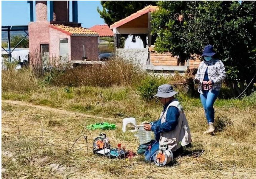
*Figura 31. Mediciones de resistividad eléctrica en campo mediante el método SEV.*
