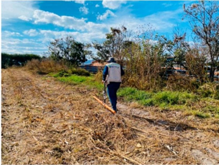
Figura 16. Estudio de conductividad eléctrica utilizando el medidor PEM en ruta o en perfil.
