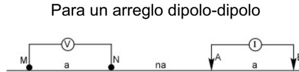
*Figura 4. Arreglo dipolo-dipolo.*
