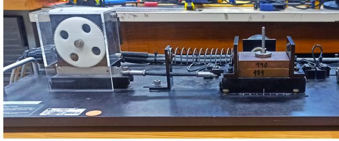
**Figura 4.11:** Configuración de un sistema mecánico de un grado de libertad en la plataforma ECP 210a.
