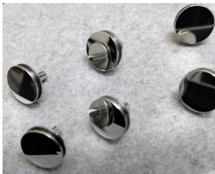
Figura 14. Preparación del sustrato (pines de aluminio) pulido a espejo.
