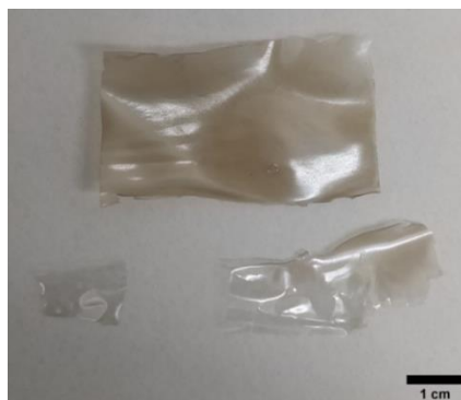
Figura 42. NFCs-RA obtenidas del sargazo (a) en comparación con las NFCs-Aldrich (b)
