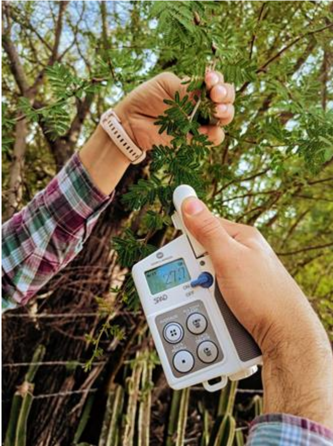
Equipo de medición de la clorofila (SPAD-502; Relative chlorophyll content)
