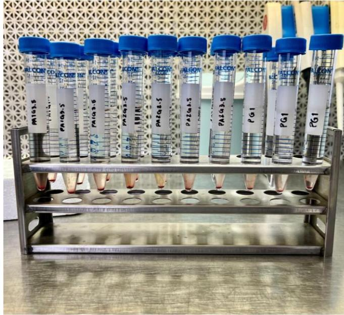
Figura 20. Ejecución de la prueba de hemólisis. Los tubos Falcon contienen la solución de eritrocitos en presencia de los materiales a evaluar.
