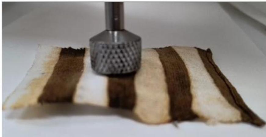
Fig. 16 *Comprobación rápida con un imán de crecimiento de cristales de magnetita sobre tela de algodón.*
