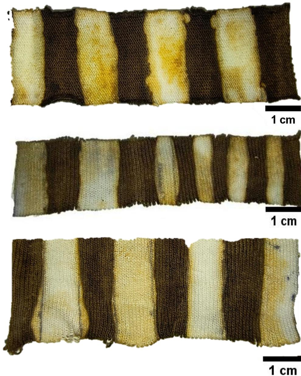
Fig. 17 Muestras sintetizadas sobre tela de algodón por el método de coprecipitación química, alternando zonas con y sin material magnético con anchos de 1 cm y 5 mm.
