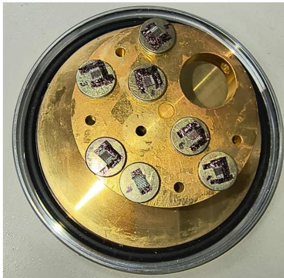
*Fig. 13. Recubrimiento de muestras con oro.*
