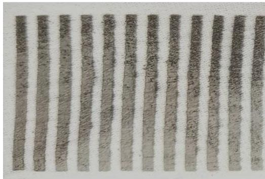
Fig. 26 Recubrimiento con pintura en aerosol de níquel (MGChemicals) por el método de serigrafía sobre tela de algodón con  $d=1.818\text{ mm}$
