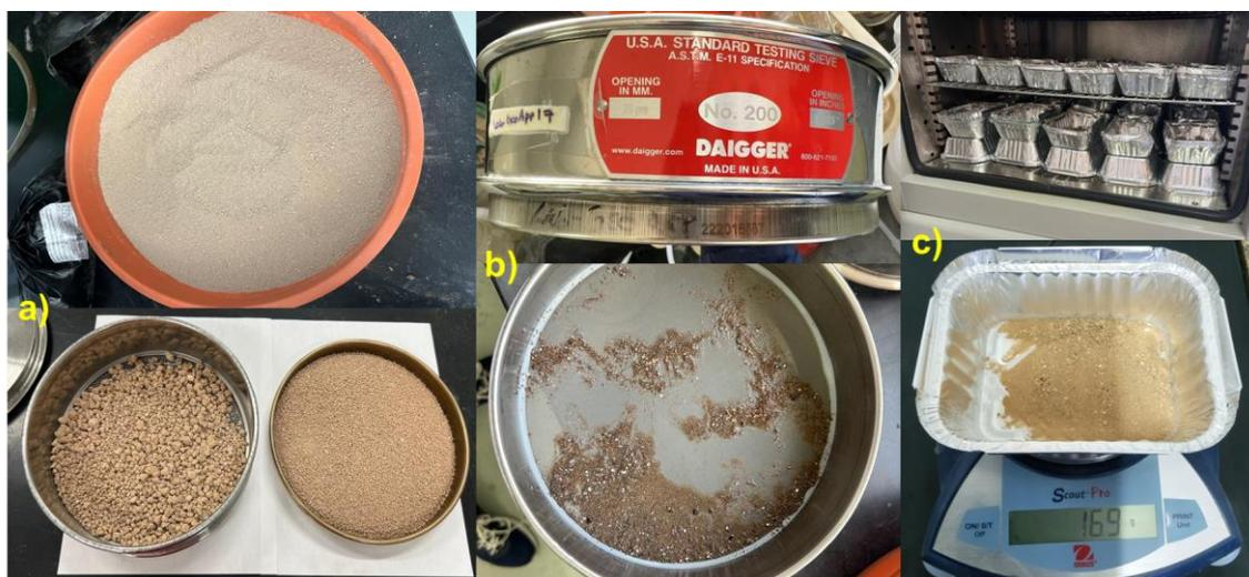
Figura 2.3. Proceso de tamizado para determinar la textura del suelo: a) secado al aire y separación de la fracción menor a 2 mm, b) tamizado en húmedo a través de una malla ASTM No. 200 (0.074 mm) hasta obtener agua clara y c) secado del residuo a 105 °C por 16 o 24 h y determinación del peso de las arenas retenidas.
