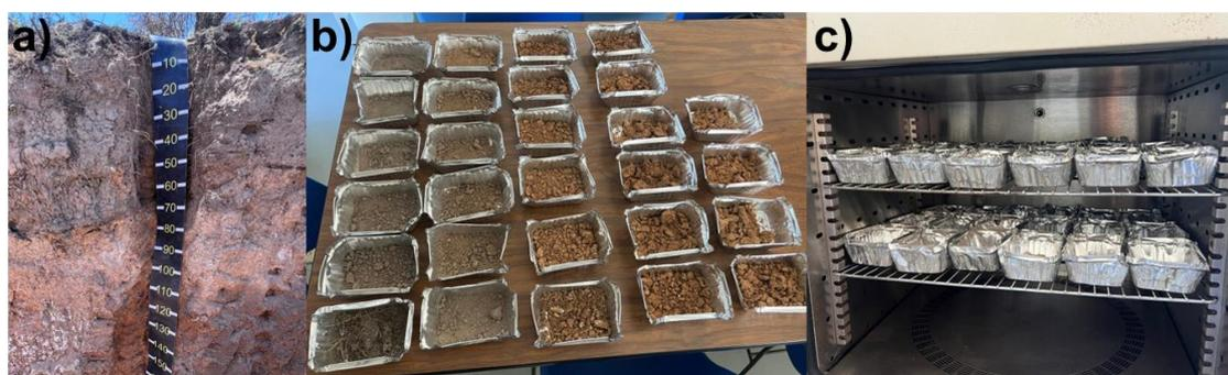
Figura 2.4. Esquema del procedimiento de muestreo de suelo para el análisis gravimétrico del contenido de agua: a) perfil de suelo muestreado cada 10 cm, b) lote de muestras de suelo para determinar humedad y c) secado de muestras de suelo para retirar humedad y calcular el contenido de agua perdida.
