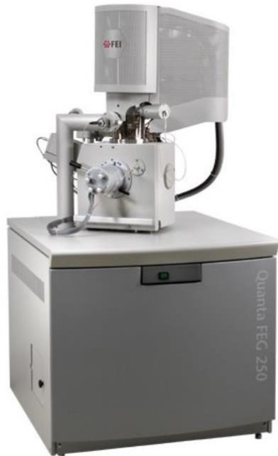
Figura 2.8. Microscopio Electrónico de Barrido FEI ESEM-Quanta FEG-250.
