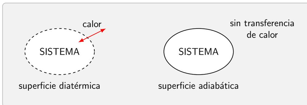
Figura 2.2: Tipos de superficies de separación térmicas.
