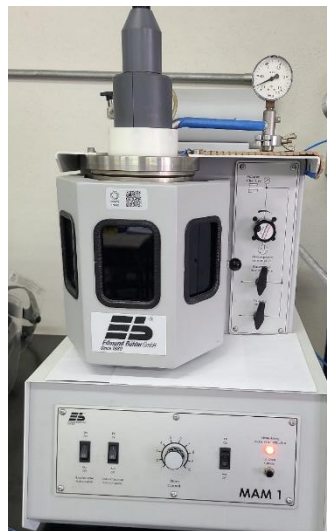
Figura 16. Horno de arco eléctrico Edmund Bühler modelo Compact Arc Melter MAM-1
