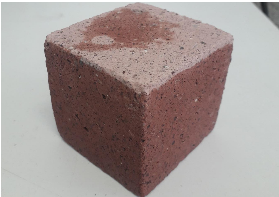
Figura 62. Muestra A4-B al finalizar la prueba de absorción de agua por capilaridad donde se nota cómo el agua logra saturar prácticamente todo el cubo.
