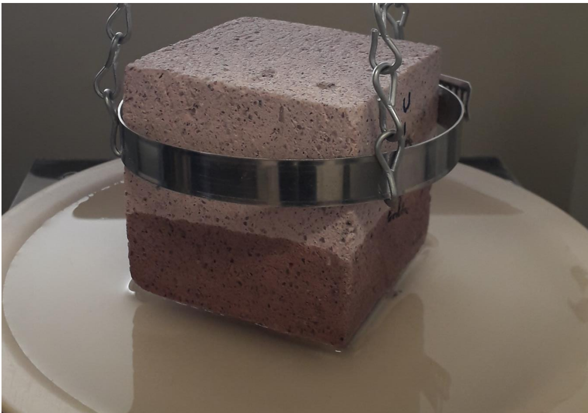
Figura 58. Prueba de absorción de agua por capilaridad en donde una cara del cubo tiene que estar en contacto con la superficie del agua para que esta absorba agua del menisco.
