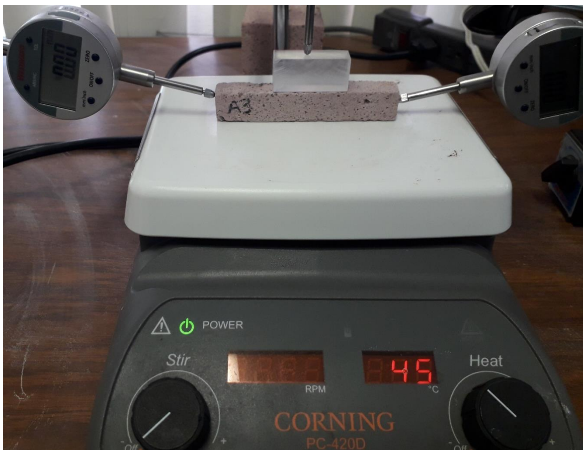
Figura 60. Prueba de expansión térmica en donde se observa la configuración elegida para medir los cambios de longitud de la muestra en dos ejes.
