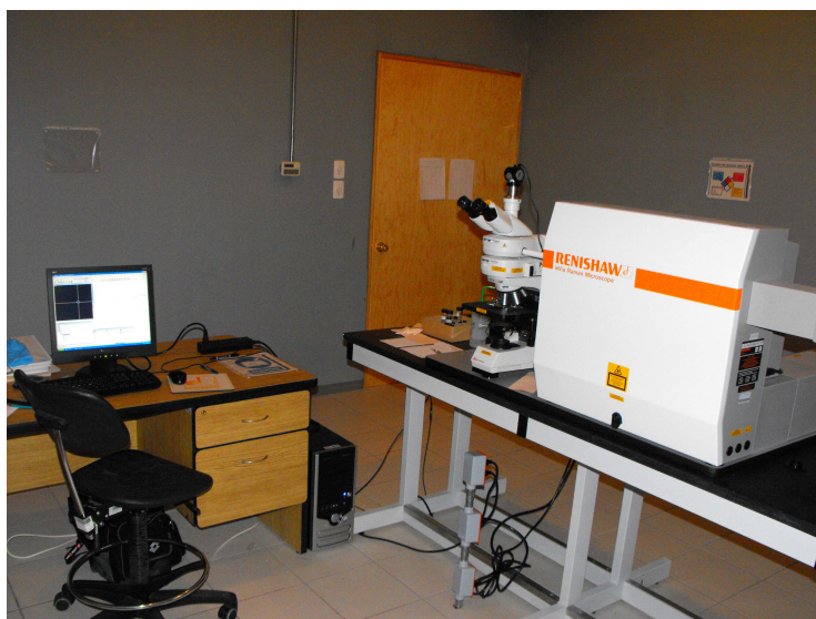
Fig. 2.27: Equipo experimental de espectroscopía Raman. En la imagen se muestra el sistema de espectroscopía Raman utilizado en esta tesis. Esta técnica sirve para conocer las interacciones entre las nanocargas y la matriz de polímero, a través de sus modos vibracionales que presenten, producto de la perturbación impuesta con lasers de diferente longitudes de onda.
