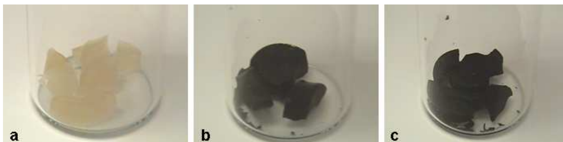
Fig. 4.3: Materiales compuestos obtenidos por sol-gel. (a) Muestra de SiO x de alta pureza sin incorporar MWNTsCN x . (b) Muestra de SiO x con 50mg de MWNTsCN x . (c) Muestra de SiO 2 con 50mg de CN x sinterizado.
