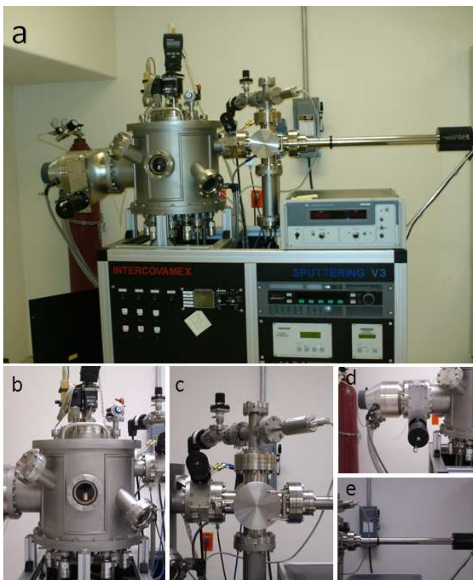
Fig. 2.5: Vista General del sistema empleado en el DMA-IPICYT. A) Bomba turbomolecular de la cámara de deposición y válvula. B) Cámara de deposición, dentro de la cámara se cuenta con 6 magnetrones: 3 de ellos para blancos de 1" y 3 para blancos de 3". Para medir la presión, cuenta con dos sensores: un pirani y un cátodo frío. En la parte superior se encuentra un sistema para rotar la muestra durante el depósito. C) Cámara de introducción. Esta es la cámara por donde se introducen y extraen las muestras, cuenta con una bomba rotatoria y una turbomolecular, así como dos sensores de presión: un pirani y un cátodo frío. En la parte posterior se encuentra una resistencia la cual hace que esta cámara también pueda funcionar como evaporadora. D) Brazo magnético. Con este brazo se trasladan las muestras desde la cámara de introducción a la cámara de deposición.
