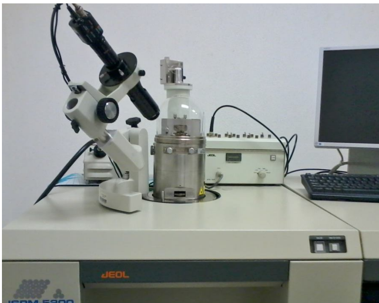
Figura 3.2.2.4. Fotografía del Microscopio de Fuerza Atómica JEOL JSPM-5200 disponible en el Laboratorio Nacional de Investigaciones en Nanociencias y Nanotecnología (LINAN) del IPICYT.
