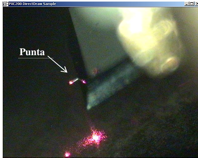
Figura 3.2.2.1.2. Luz del láser posicionado sobre la punta después de ser alineada.
