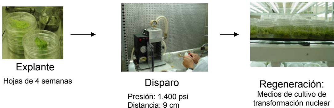
Figura 33. Proceso de transformación de hojas de tabaco por el método de biobalística.
