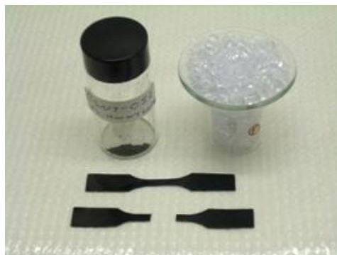
Figura 4.4: La Imagen muestra a MWNTs funcionalizados con polímero en forma de polvo; los nanotubos funcionalizados son mezclados en estado fundido con polímero puro en forma de pellet. El composite resultante fue moldeado por compresión a 115 °C y cortado en forma de probeta tipo V. La probeta fue sometida a elongación hasta la fractura en una máquina universal.
