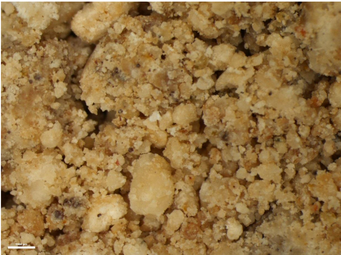
Figura 31 Material limo-Arcilla observado al microscopio (Luz: natural, Objetivo: 1X, Escala: 1000 µm)
