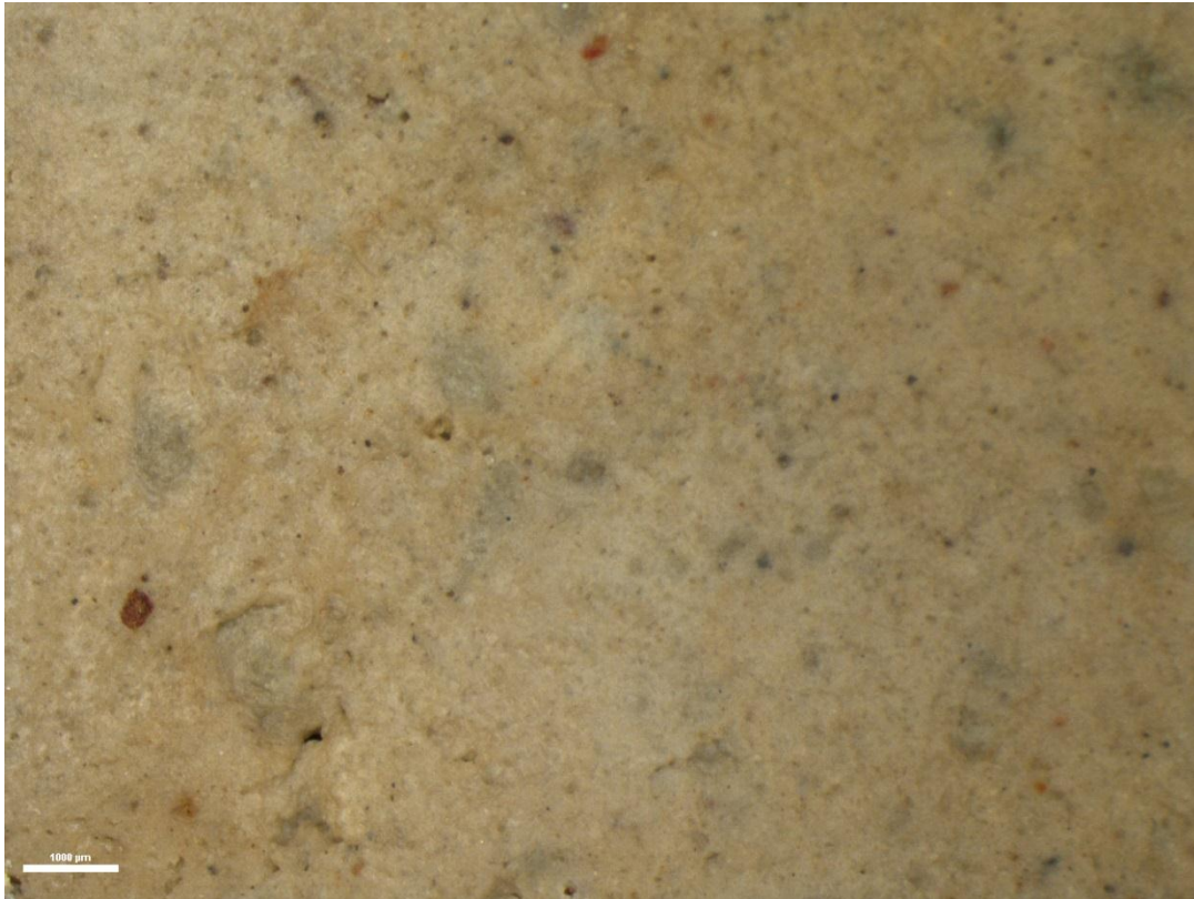
Figura 32 Material arcilloso extremadamente plástico (Luz: natural, Objetivo: 1X, Escala: 1000 µm).
