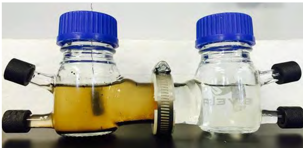
Fig. 9 Celda de electrólisis microbiana empleada; cámara anódica (izquierda) y cámara catódica (derecha).
