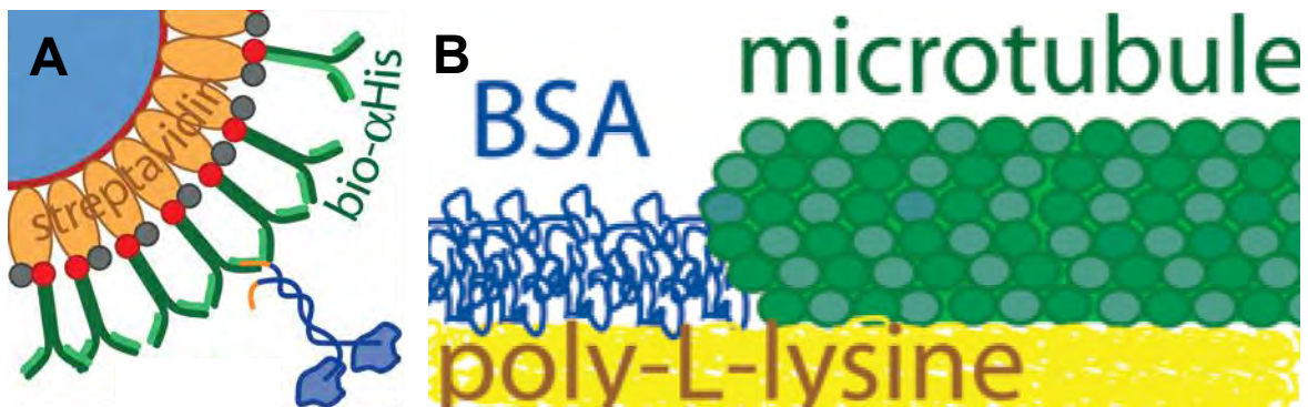
Fig. IS1. Dibujo de los elementos que permiten la unión esfera-cinesina y tratamiento de la superficie para un ensayo de motilidad. A: Una esfera de poliestireno (azul cielo) está recubierta de estreptavidinas (óvalos amarillos), éstas unen la biotina (círculos rojos) acoplada a cada anticuerpo (verde), el anticuerpo a su vez reconoce la etiqueta de 5xHis (amarillo) de la cinesina (azul oscuro). El cálculo de la longitud del tallo de la cinesina trunca DmK401 es de \approx 10 nm, en tanto que la longitud del atado estreptavidina-biotina-anticuerpo es de \approx 20 nm [34]. B: Los MTs (superficie con carga negativa) se adhieren al cubreobjetos por la interacción de su carga con la de la poli-L-lisina (carga positiva). La BSA actúa como agente bloqueador para que las esferas no se peguen al vidrio vía adsorción no específica [43]. Imágenes de la referencia [42].
