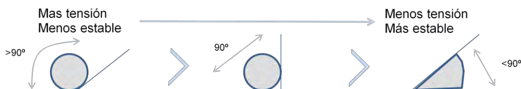
Figura 2.5. Representación esquemática del fenómeno de tensión superficial
