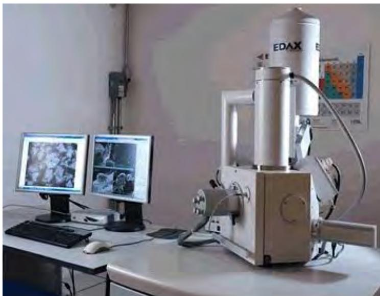
Figura 2.5 Microscopio electrónico de barrido modelo QUANTA 200 ESEM.
