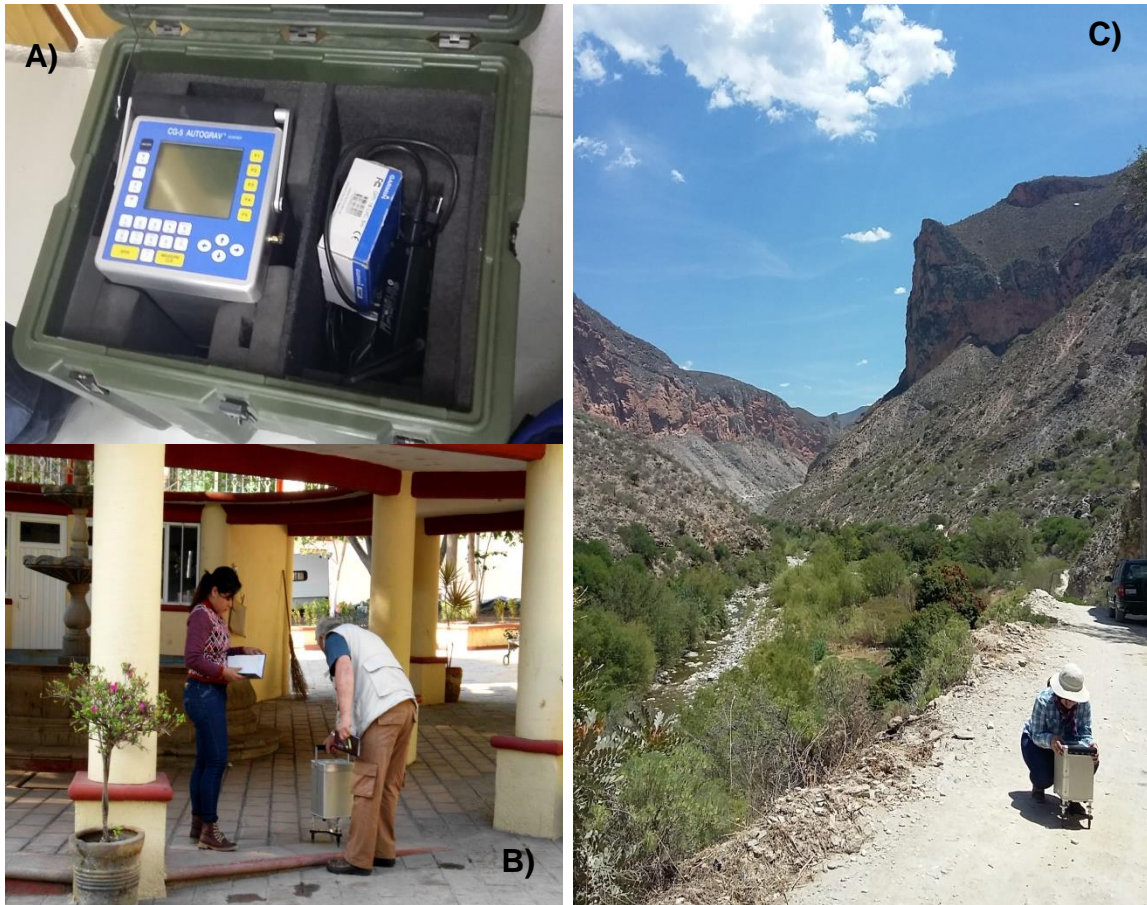
Figura 24. Gravimetría terrestre. (A) Gravímetro Scintrex CG-5 Autograv, (B) estación base en el Kiosco de la plaza principal en Peñamiller y (C) medición en campo.
