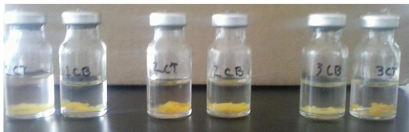
Figura 5.3. Prueba de arseniato reducción positiva. Se formó el precipitado amarillo instantáneamente para cada alícuota tomada.
