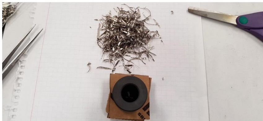
Figura 31. Preparación de las cintas para el SPS.
