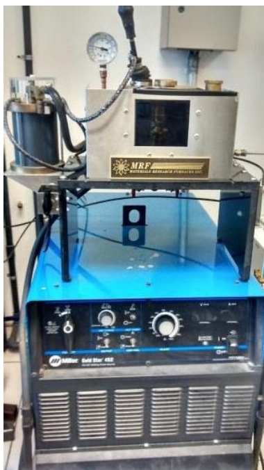
Figura 23. Horno de arco eléctrico utilizado.
