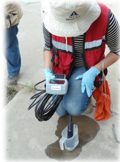
Fotografía 2.4A. Determinación de parámetros físicos mediante la utilización del multiparámetro HANNA.
