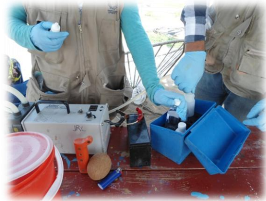
Fotografía 2.6A. Filtrado y determinación del parámetro dureza.
