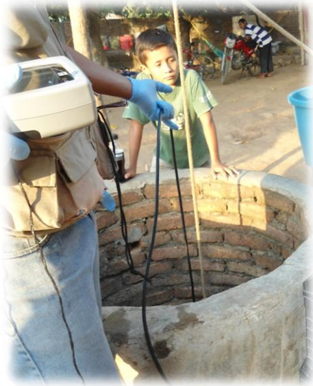
Fotografía 2.3A. Determinación de parámetros y toma de muestra proveniente de una noria.
