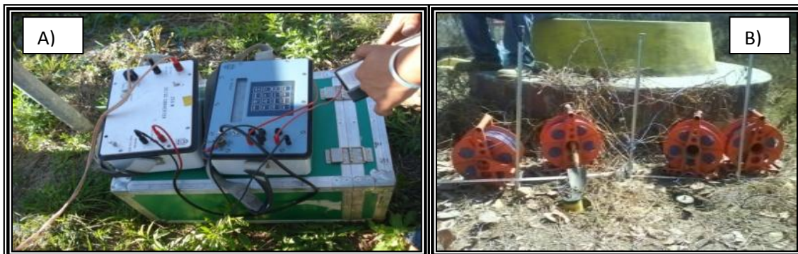
Figura 5.3. a) Receptor y transmisor SYSCAL R-2, b) Electrodo y carretes.
