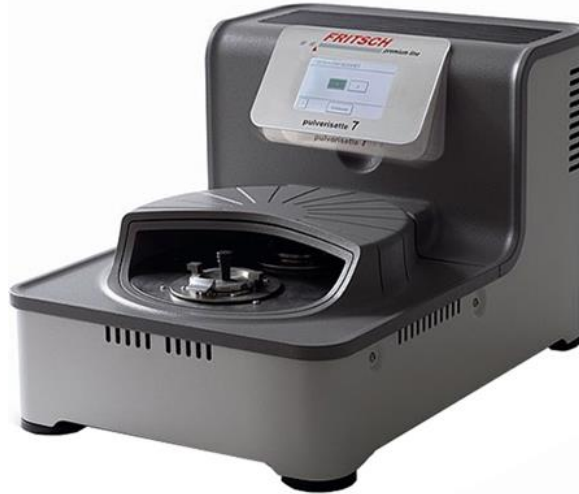
Figura 1. Molino planetario marca Fritsch Pulverisette 7 premium line con dos estaciones de trabajo, tamaño de tazones de 20, 45 y 80 mL, velocidad del disco principal 100 a 1100 rpm [5].
