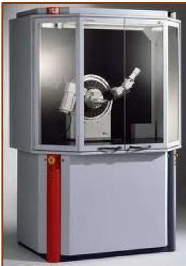
Figura 6. Difractómetro de rayos-X en polvos Bruker D8 Advance con fuente de radiación de \text{CuK}\alpha de \lambda=1.5406 \text{ \AA} .
