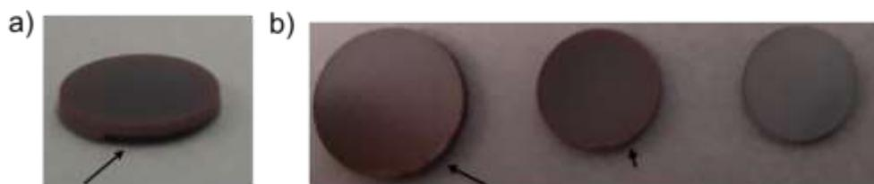
Figura 41. Defectos destacados con las flechas en las pastillas de a) Ba-M sinterizada a 920 °C y b) Pb-M, la primer pastilla es el material sin el segundo tratamiento térmico y las que siguen corresponden a tratamientos de 920 y 960 °C respectivamente. Nótese la evidente densificación conforme se aumenta la temperatura de sinterizado.
