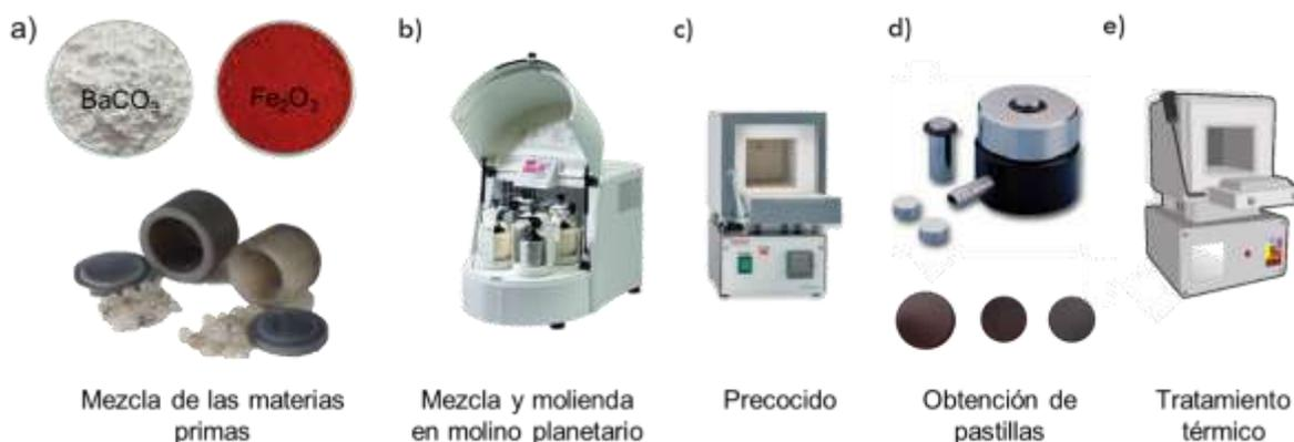
Figura 23. Esquematización de la síntesis vía cerámica.
