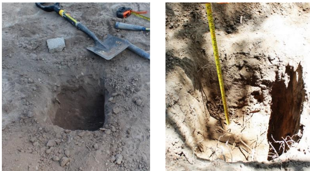
Figura 17. Muestreo de suelo, a la izquierda se muestra la excavación para recolectar muestra superficial de 0-30 cm y, a la derecha se muestra el pozo realizado para el muestreo en columna de 0-60 cm.
