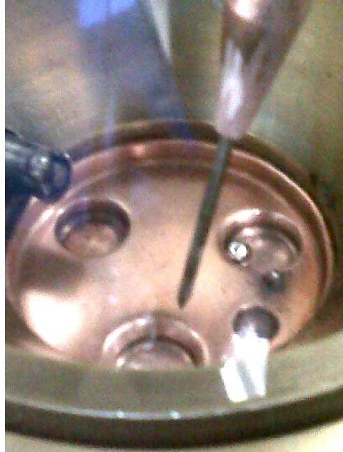
Figura 2.2: Vista del crisol de cobre dentro de la cámara de fundición.
