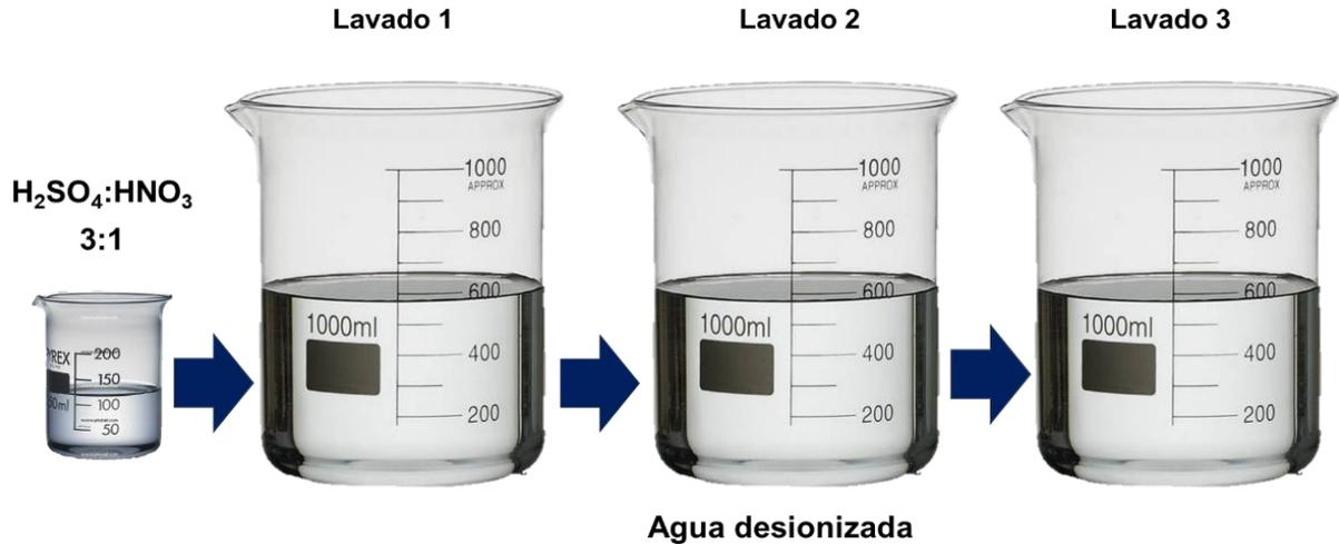
**Figura 2.2.** Procedimiento para la funcionalización de las esponjas de carbono utilizando una mezcla de ácidos fuertes.
